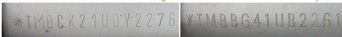
Obrázek 7. Příklad originálního a padělaného čísla VIN [11]
