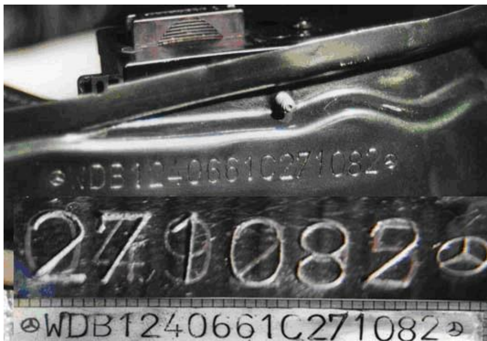
Obrázek 9. Ukázka přeražení čísla VIN [11]
