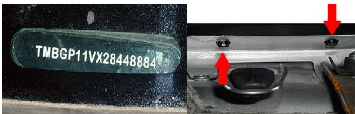
Obrázek 6. Příklad VIN umístěného pod čelním sklem [11]
