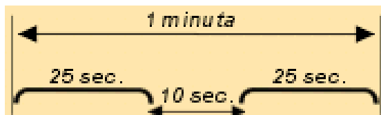
Obrázek 2 Požární poplach [Zdroj:vlastní]
