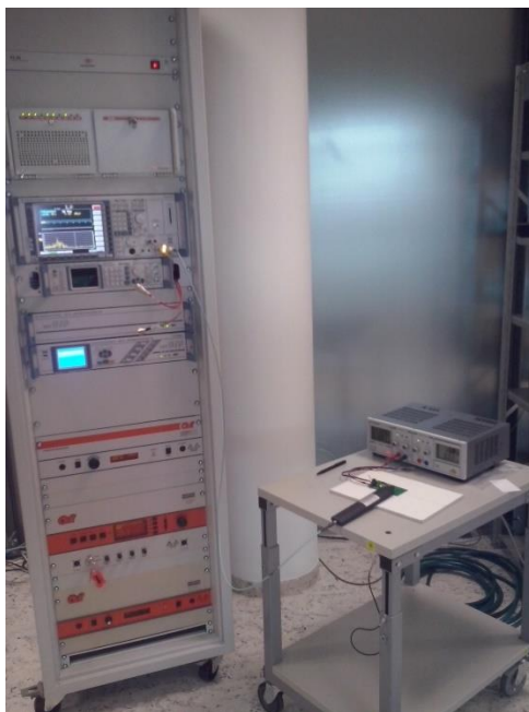
Obr. 29 Připojení sondy ke spektrálnímu analyzátoru, vlastní zdroj
