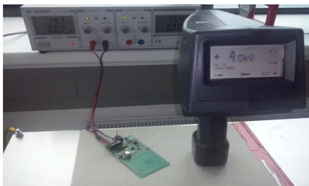
Obr. 27 Aplikace ESD na zkoušené zařízení, vlastní zdroj
