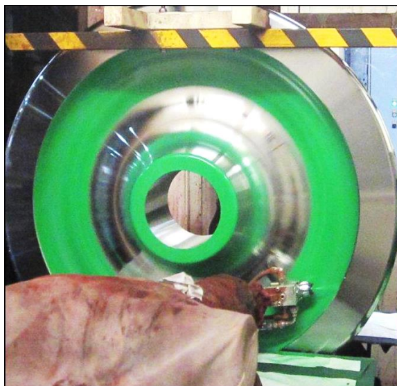
Obrázek 36: Foto robotického lakování
