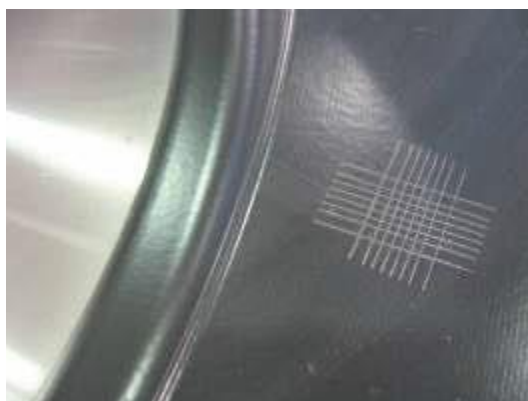
Obrázek 25: Test kontroly přilnavosti nátěru
