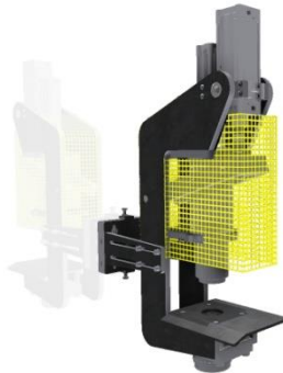
Obrázek 22 Vysekávačka vzorků [vlastní zpracování]
