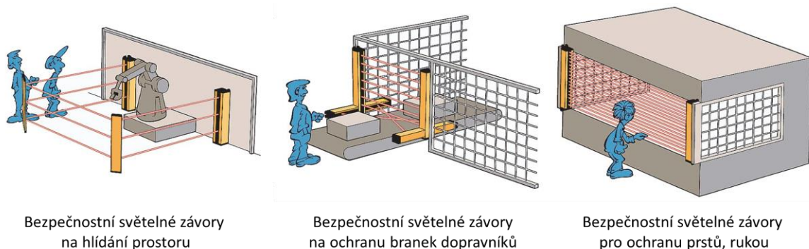
Obrázek 6 Použití bezpečnostních světelných závor [13] (upravil Štach 2014)
