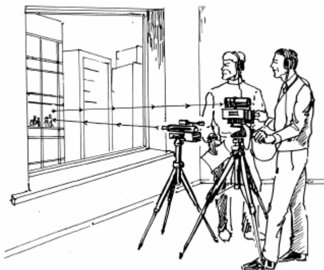
Obrázek 16 – Laserový odposlech, vysílač + přijímač [9]
