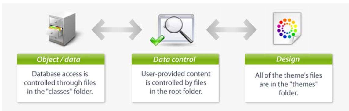
Obrázek 1 – Schéma architektury systému PrestaShop [9]
