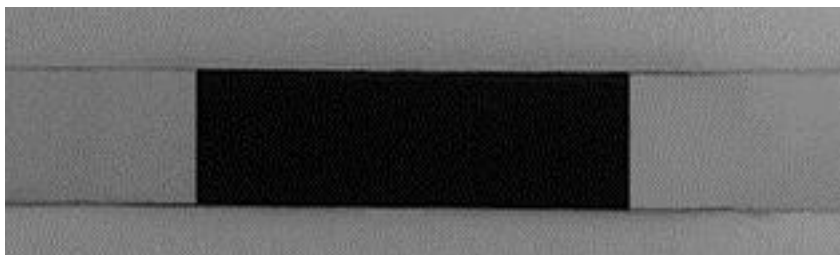
Obrázek 19 Vzorek – PU pásek s MWCNT aktivní vrstvou
