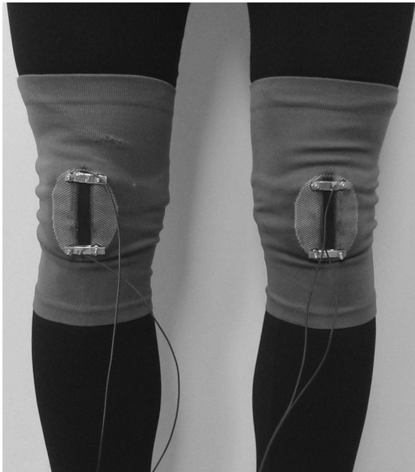
Obrázek 32 Umístění senzorů na střed dvou lidských kolen
