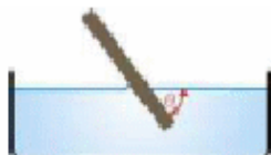
Obr. 16 Měření úhlu smáčení \theta na nakloněné destičce [23]
