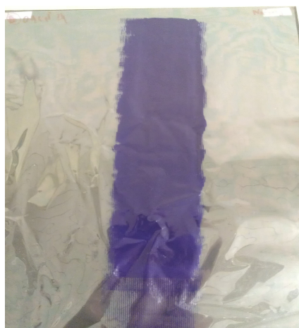
Obr. 36: Ukázka nánosu modré barvy spirálovým pravítkem na 12 µm fólii
