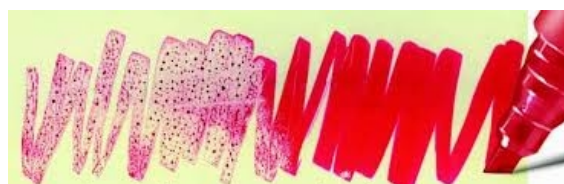
Obr. 20: Princip nanášení fixy, vlevo neošetřený povrch, vpravo ošetřený [33]
