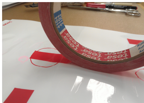
Obr. 35: Testování adheze nánosu páskou Tesa 4104
