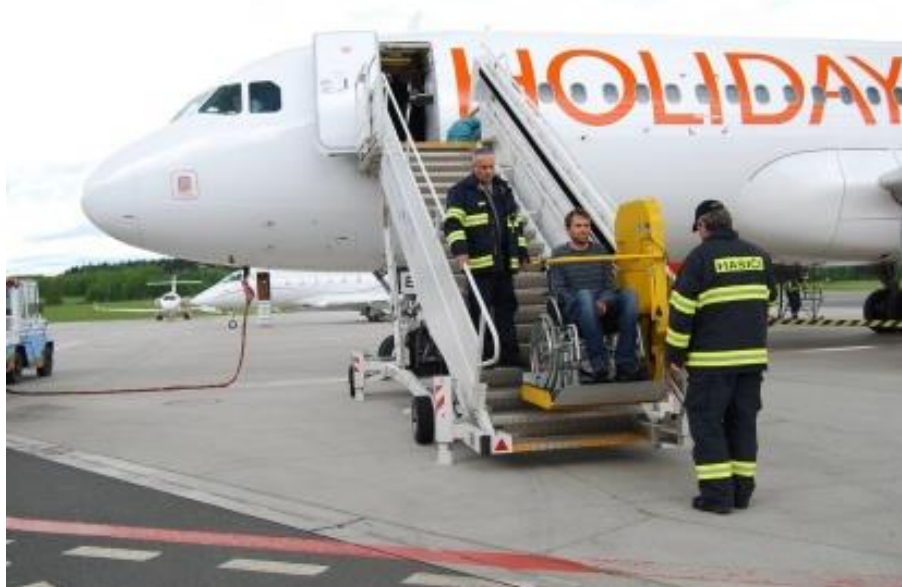
Obr. 8. Plošina pro letadlové schody
