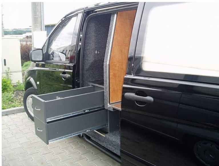
Obr. 7. Úložný prostor vestavby
