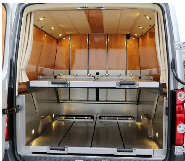
Obr. 10. Vestavba pro převoz 4 rakví - osvětlení
