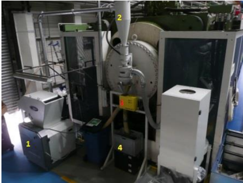
Obrázek 25 Recyklační pracoviště (1 – mlecí mlýn, 2 – odprašovací cyklón, 3 – separátor kovů, 4 – nádoby pro drť)
