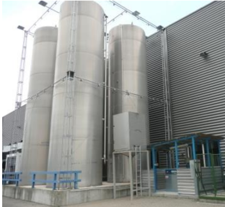
Obrázek 22 Sila pro uskladnění materiálů na levé straně obrázku a generátorem podtlaku dopravy materiálu na pravé straně obrázku
