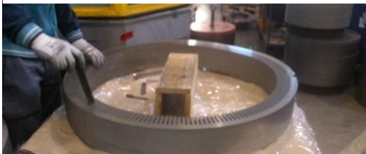
Obrázek 14 Tzv. rondel po drážkování
