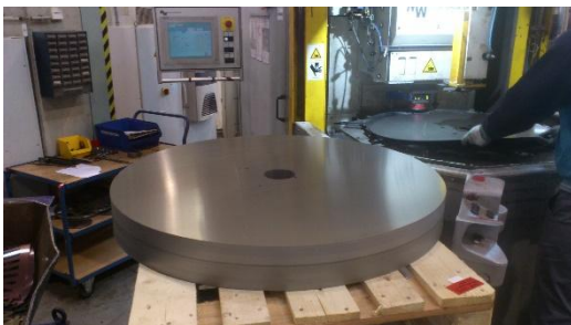
Obrázek 13 Tzv. rondel před drážkováním
