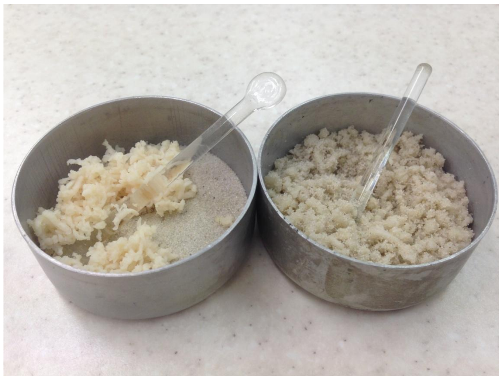
Obr. 4: Hliníkové misky se vzorkem a mořským pískem
