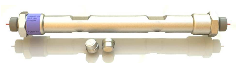
Obr. 15 Analytická kolona a předkolony [vytvořeno autorem, Rhinoceros 4.0]
