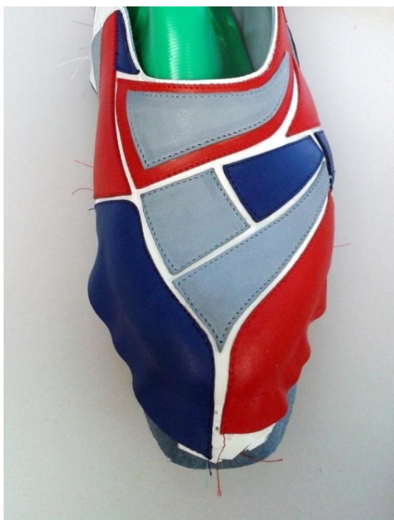
Obr. č. 77: Prešitie dielikov, model č.2
