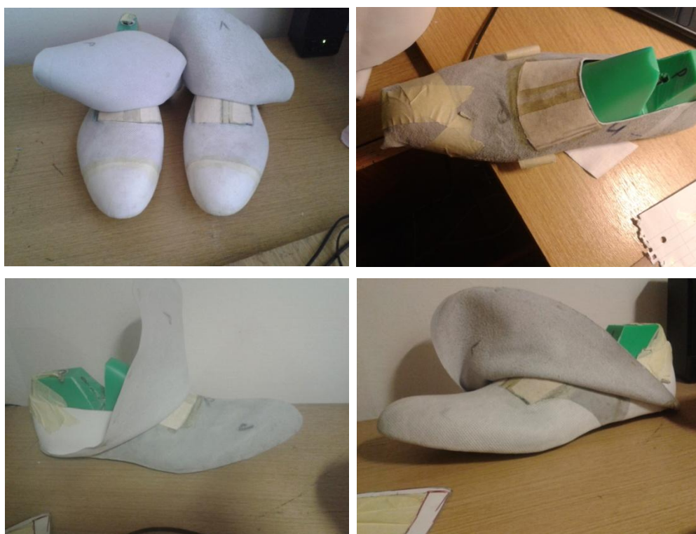
Obr. č. 67: Stuženie, model č.1
