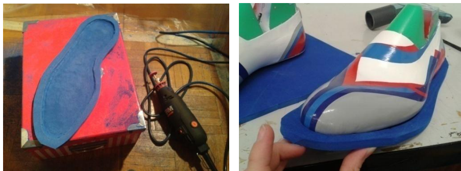
Obr. č. 70: Brúsenie podošvy, model č.1
