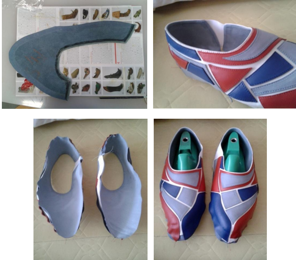
Obr. č. 78: Práca s podšívkou, model č.2
