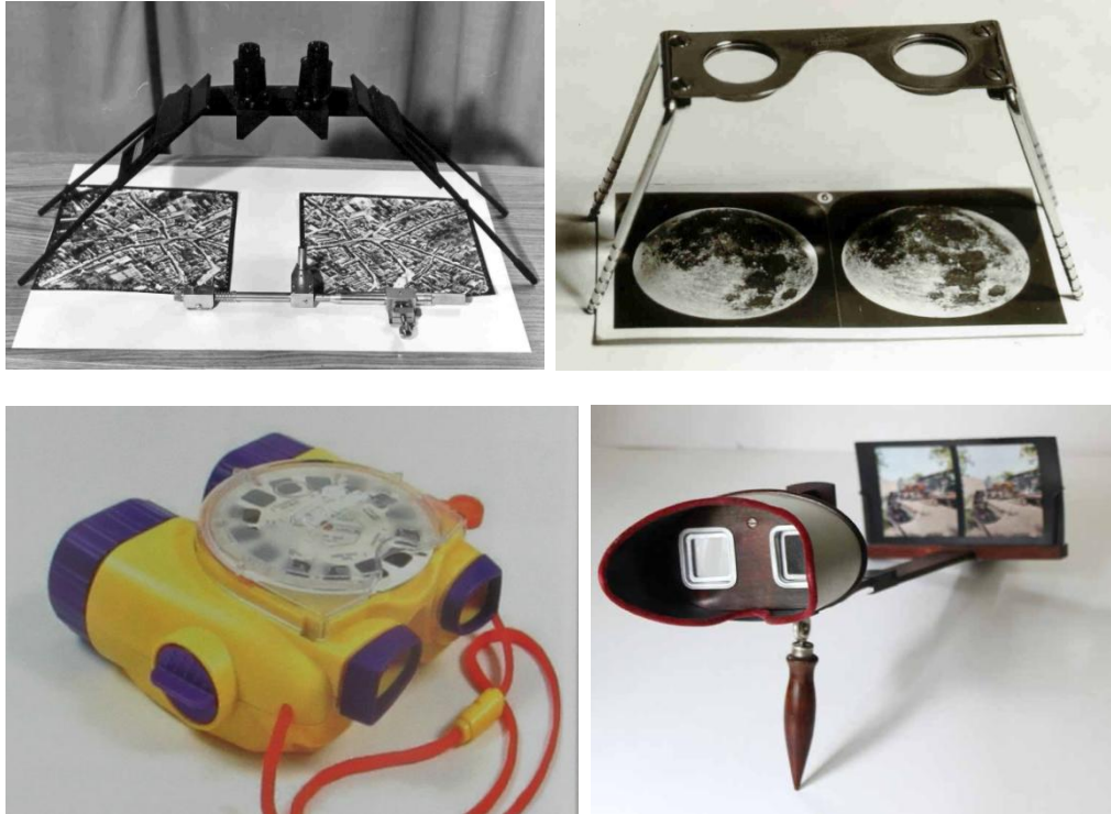
Obr. č. 7: Zrkadlový stereoskop, Obr. č. 8: Šošovkový stereoskop, Obr. č. 9: Detská stereo prehlíadačka, Obr. č. 10: Stereoskop
