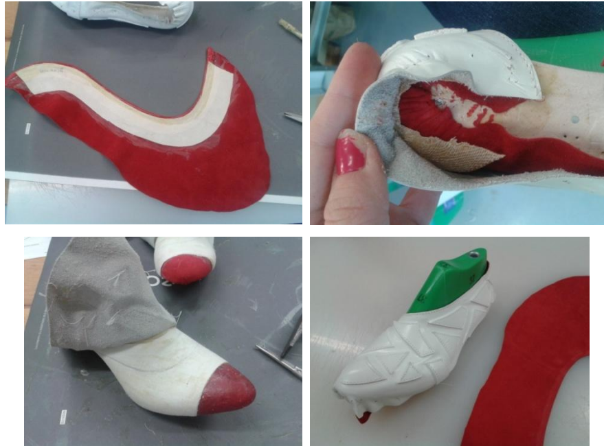
Obr. č. 85: Práca s podšívkou, stuženie, model č.3
