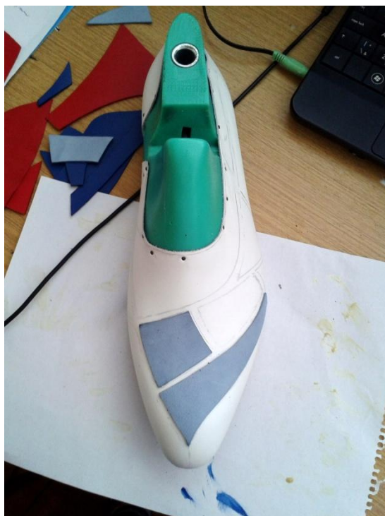
Obr. č. 76: Lepenie dielikov, model č.2
