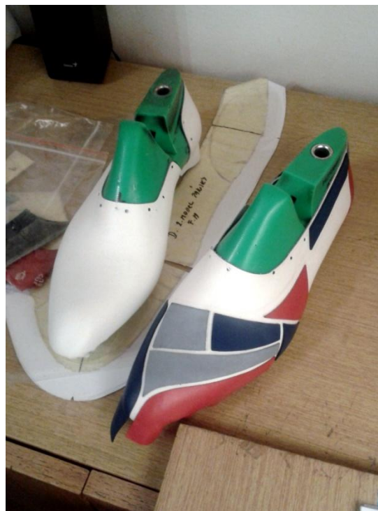
Obr. č. 76: Lepenie dielikov, model č.2
