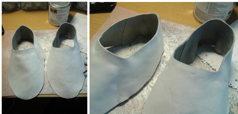
Obr. č. 66: Zlepená podšívka so zvrškom, model č.1
