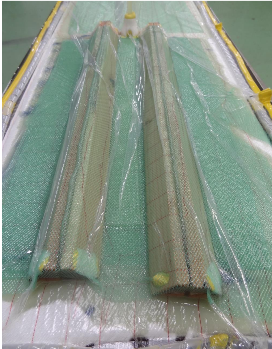
Obr. 43. Tečení pryskyřice při procesu infuze
