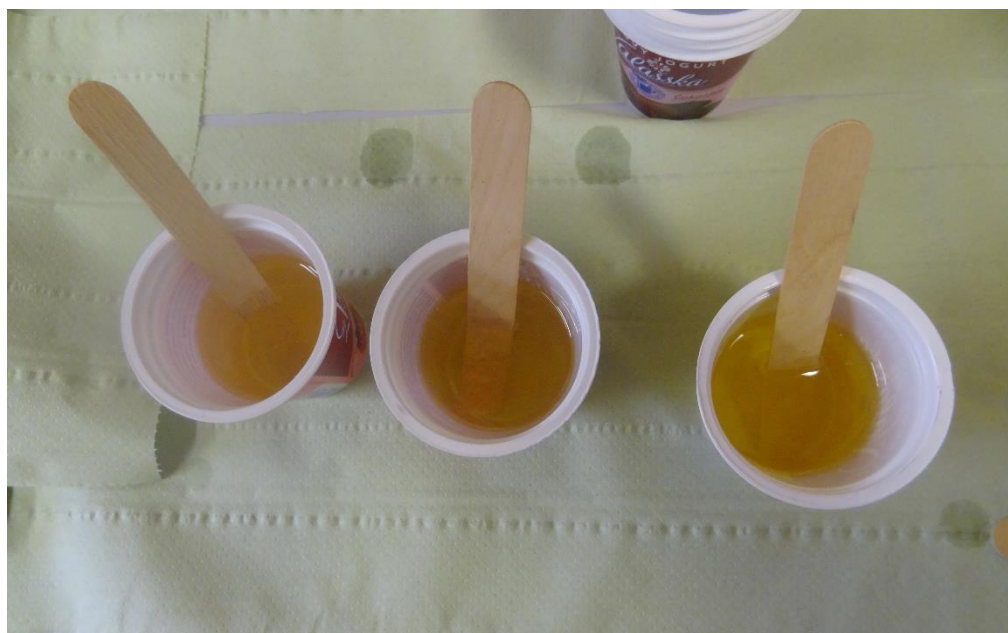
Obr. 48. Měření geltime vývojové pryskyřice
