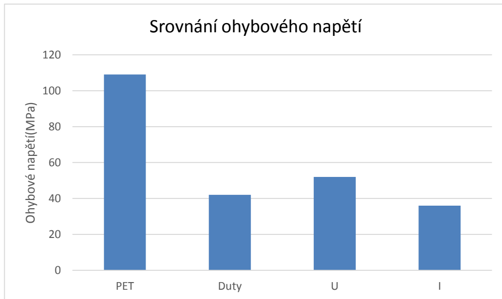
Obr. 82. Výsledné ohybové maximálního napětí z testování
