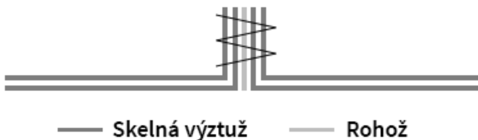
Obr. 46. Schéma „I“ profilu ze skelných výztuží
