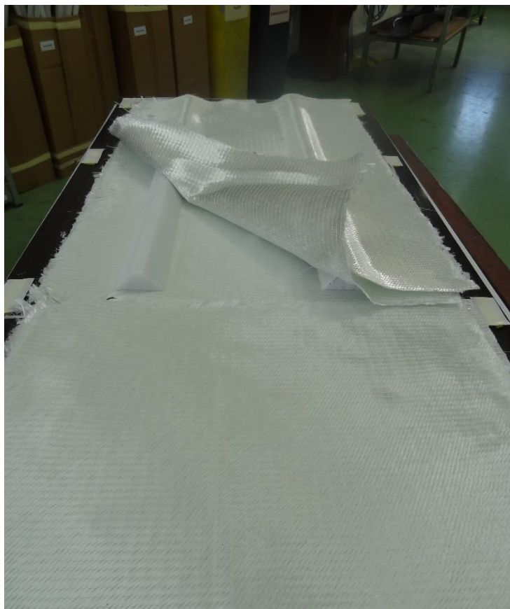
Obr. 34. Umístění PET pěny ve formě
