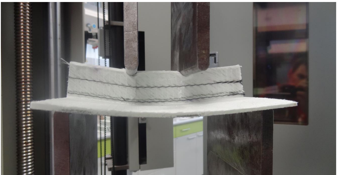
Obr. 71. Ohybové testování profilu „I“
