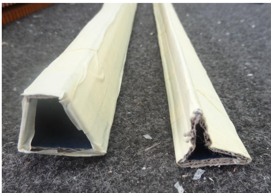
Obr. 61. Vpravo vakuem zdeformovaný profil, vlevo nezdeformovaný
