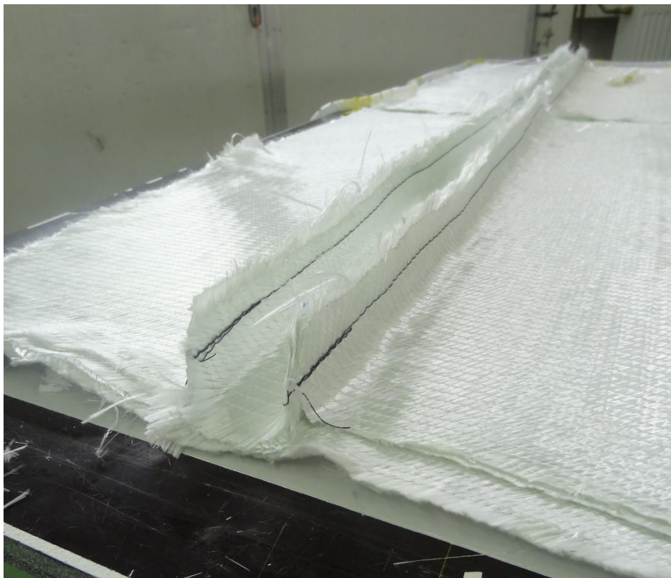
Obr. 54. Sešitý profil ve formě
