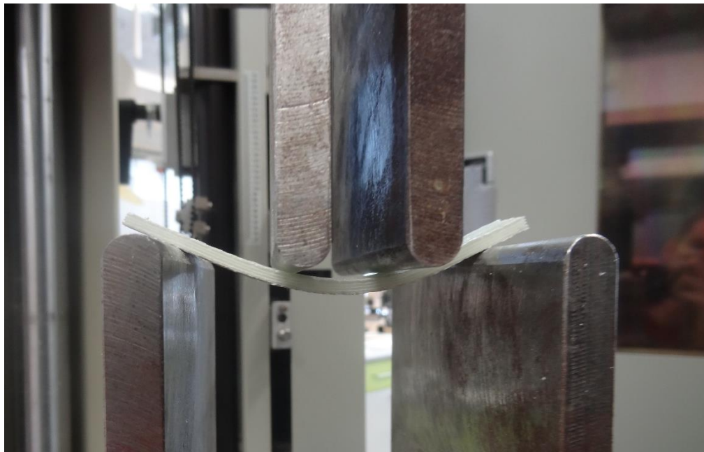
Obr. 78. 4-bodový ohyb tělíska
