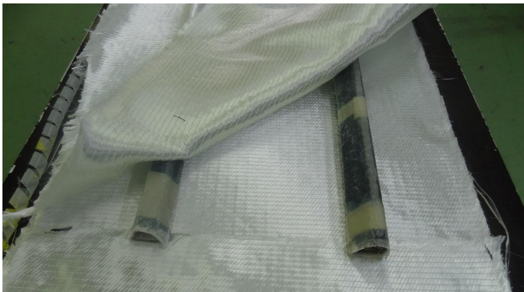
Obr. 63. Duté profily vložené mezi skelné výztuže
