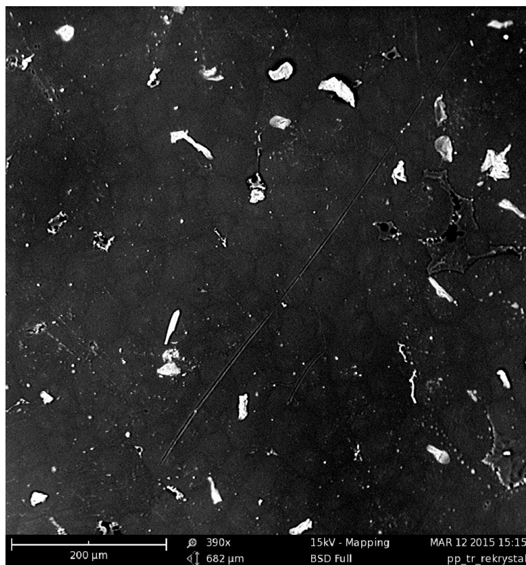
Obr. 32 – Rekrytalizovaný trámek se sférolitickou strukturou, zvětšení 390x
