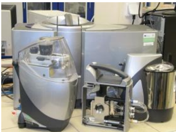
Obr. 24 Laserový analyzátor velikosti částic
