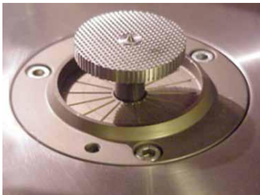
Obr. 11 Detail spodní části komory a rotoru [17]
