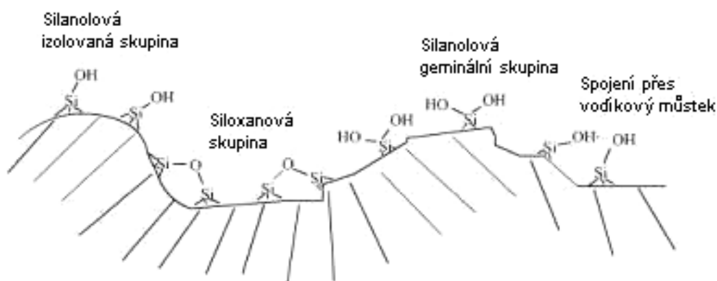
Obr. 4 Chemické skupiny na povrchu oxidu křemičitého [12]
