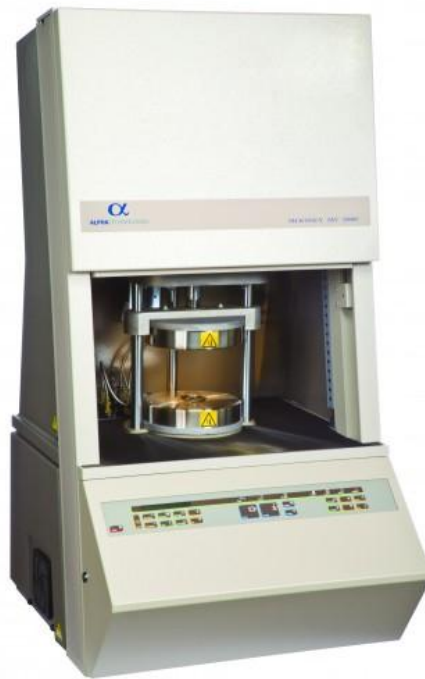
Obr. 10 Schéma viskozimetru Mooney [17]
