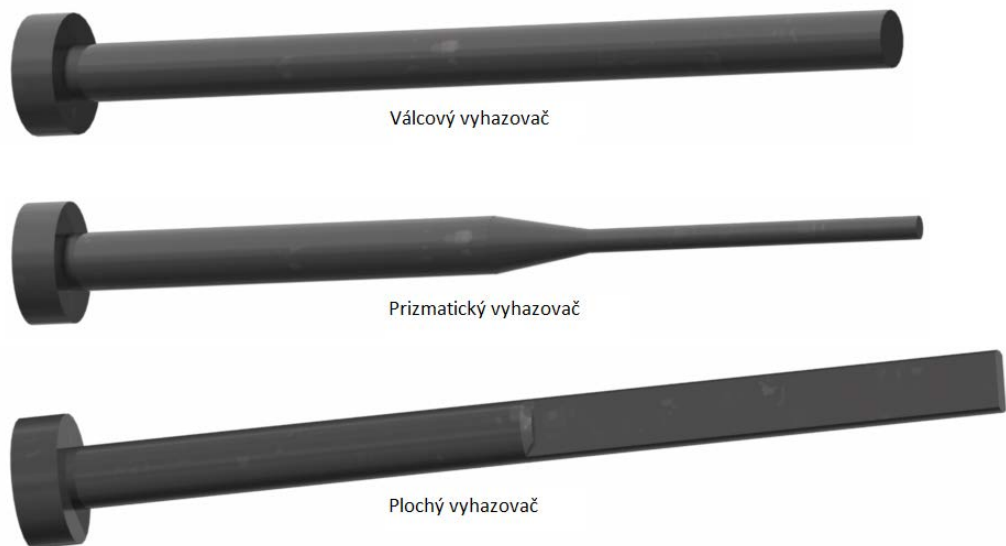
Obr. 34. Typy vyhazovacích kolíků.
