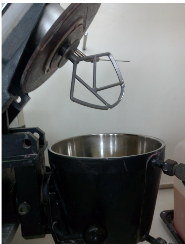
Obr. 25. Detail planetové míchačky Brabenderu plastograph
