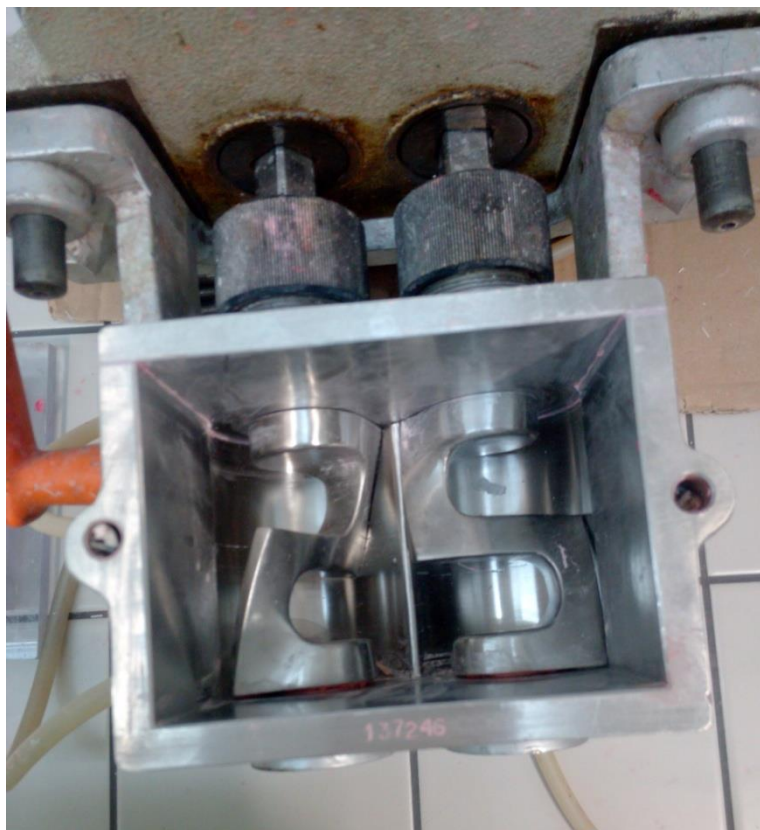
Obr. 27. Detail míchacího elementu Dvouramenného hnětiče
