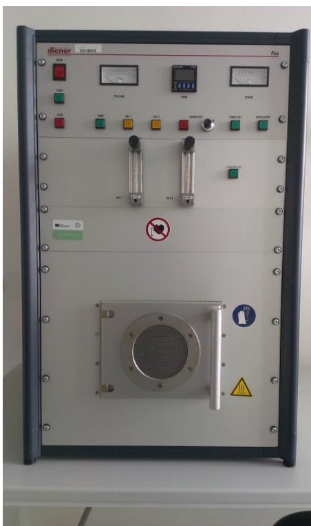
Obrázek 4: Mikrovlnný plazmový reaktor (2,45 GHz)
