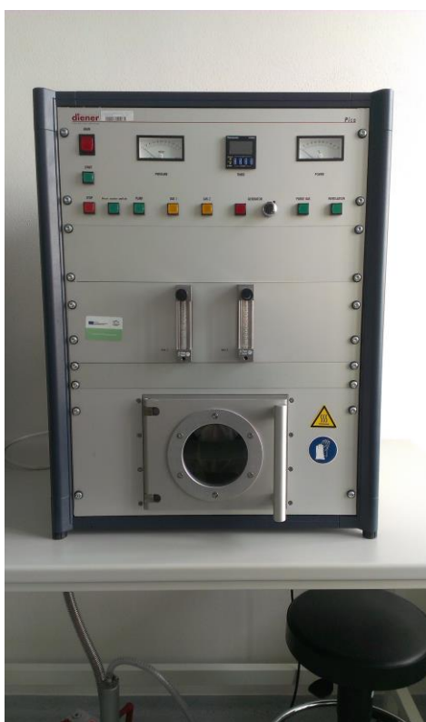
Obrázek 2: Vysokofrekvenční plazmový reaktor (40 kHz)
