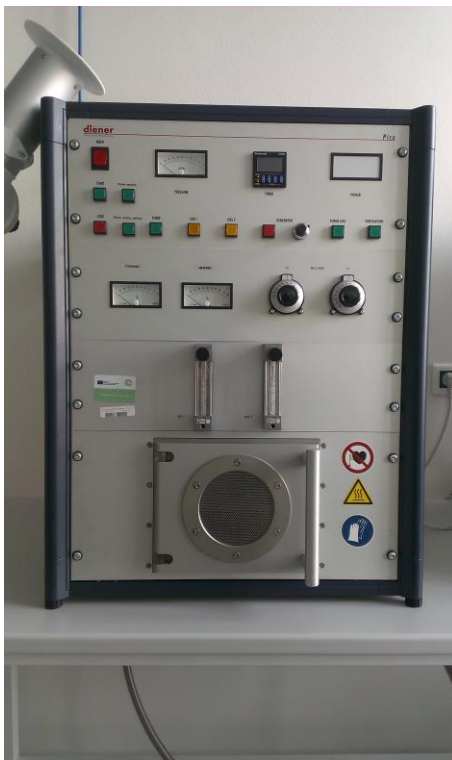
Obrázek 3: Radiofrekvenční plazmový reaktor (13,56 MHz)
