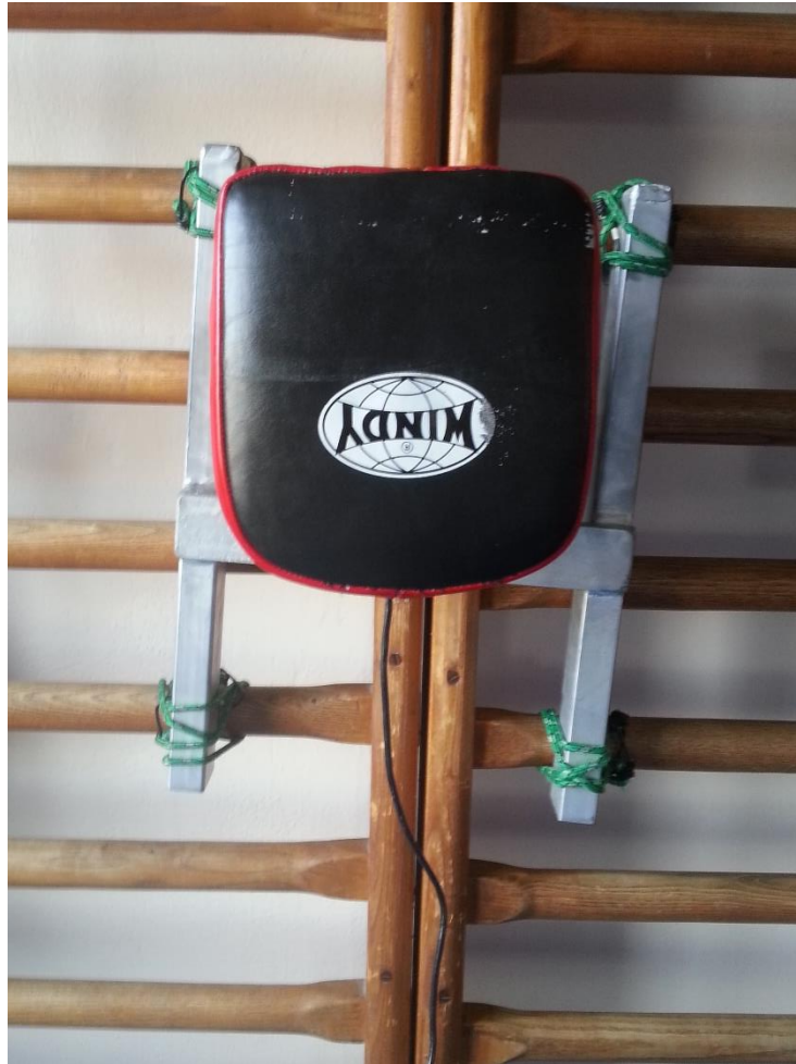
Obr. 27. Upevnění měřícího zařízení na žebřinách
