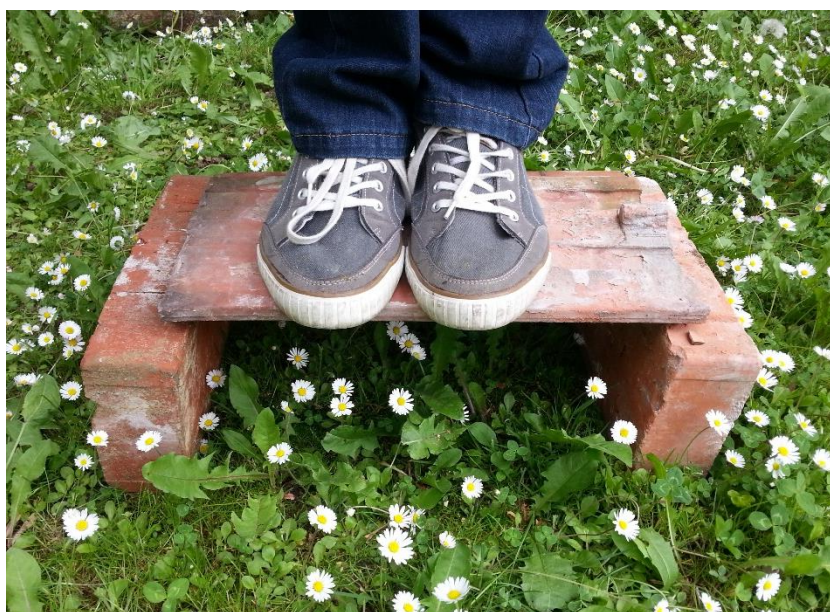
Obr. 38. Ukázka testování nosnosti střešních tašek
