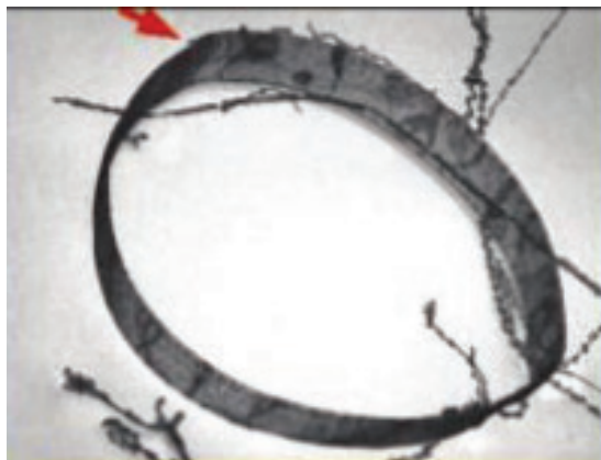
Obr. 8 Nanospirály vytvořené metodou tepelného odpařování. Při tlaku nízkého vakua a teplotě 1400 °C se ZnO rozkládá na Zn^{2+} a O^{2-} , což vede k vytvoření polárních nanopásků [38]
