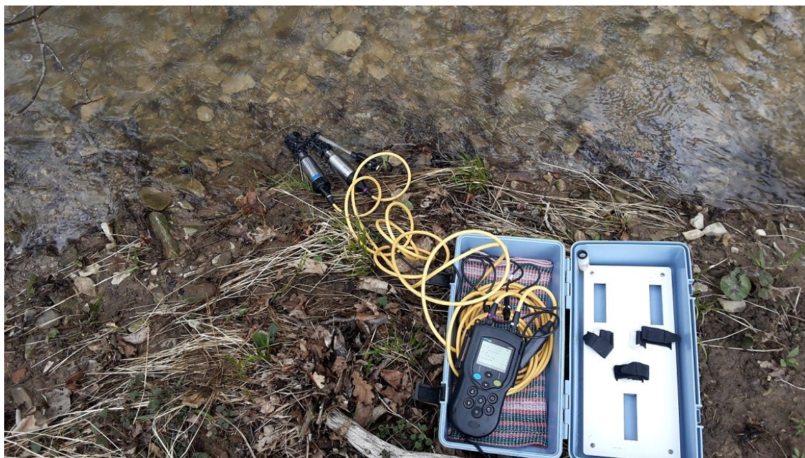
Obrázek 30: – Příklad přístroje na měření fyz. – chem. parametrů vody [vlastní zdroj]
