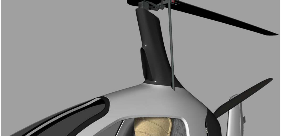
Obr. 74 Nasávací otvor v pylonu
