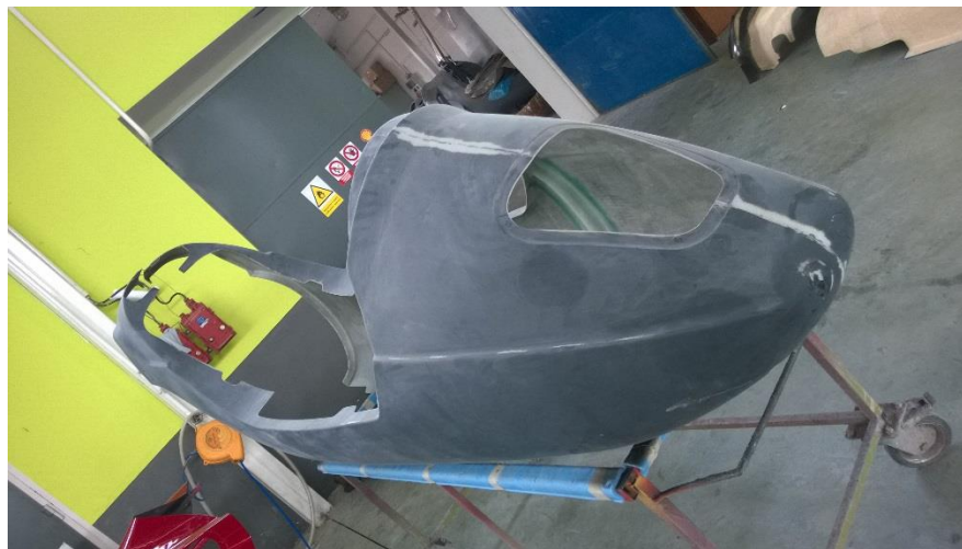
Obr. 43 Skořepina z laminátu pro MTO Sport
