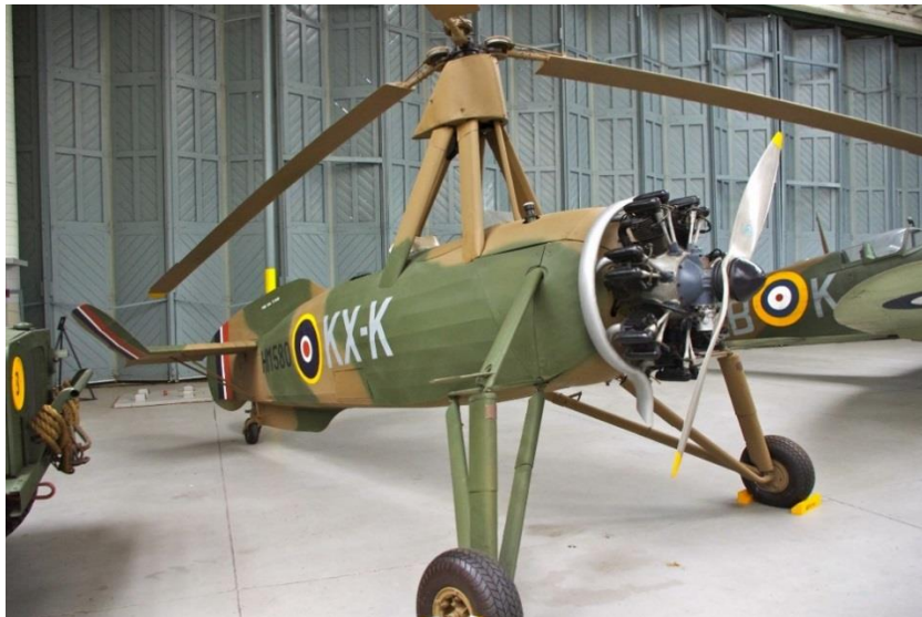
Obr. 8 Autogyro C.30 s volným uchycením rotoru
