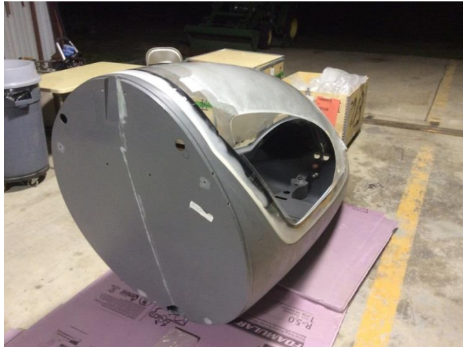
Obr. 42 Tělo Calidisu vyrobeno laminováním z kompozitů.
