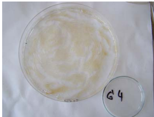
Obr. 33. Fólie G'4 25% PVAL, 25% Xanthan, 50% Hykol E + 15% glycerinu + 5% gellan
