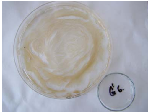
Obr. 36. Fólie G'6 25% PVAL, 50% Xanthan, 25% Hykol E + 15% glycerinu + 5% gellan
