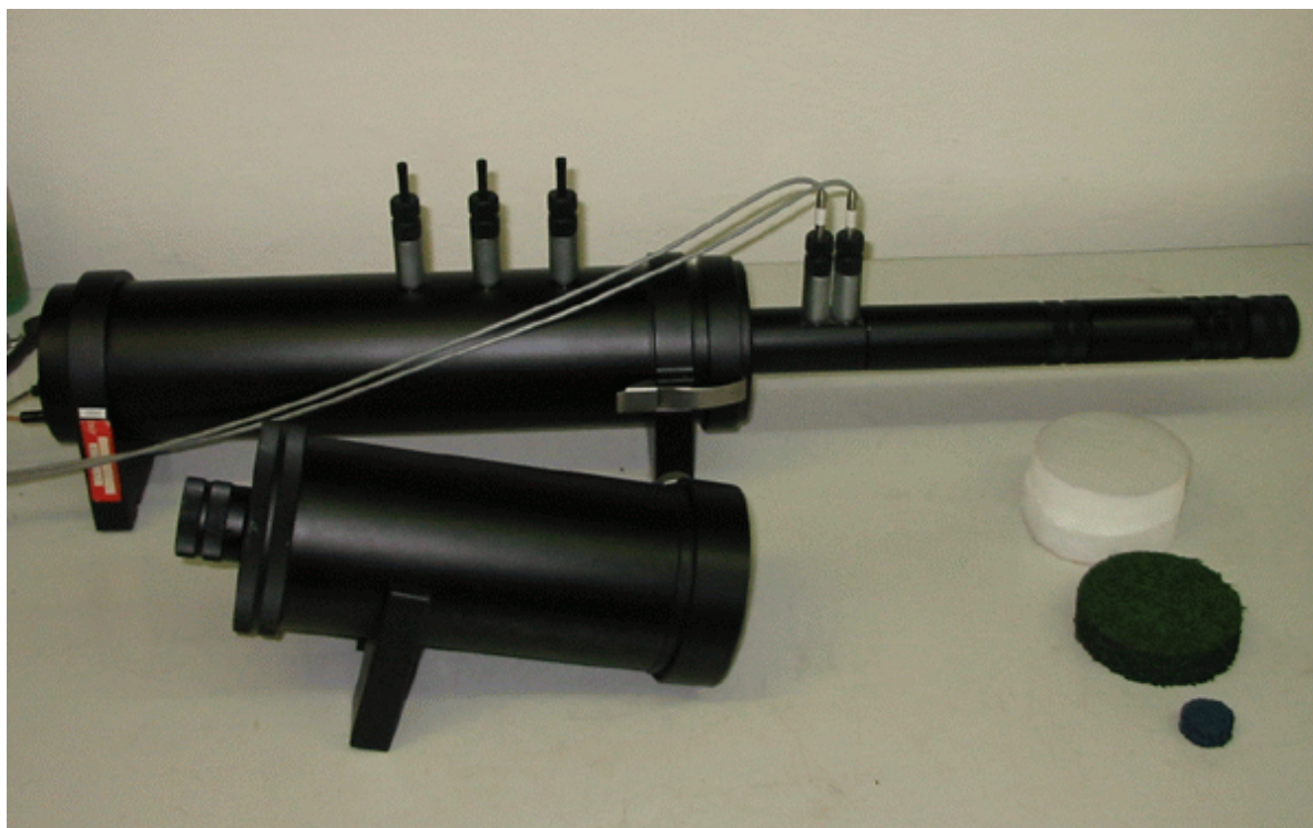
Obr.17 - Dvoumikrofonová impedanční trubice Brüel & Kjaer typ 4206
