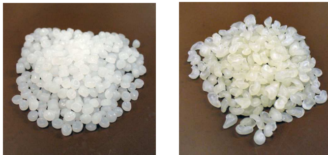
Obr. 21. Granulát polymerních materiálů Dow PP C767-07 a Scolefin 53G1
