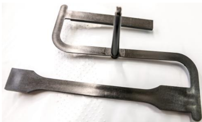
Obr. 29. Zkušební tělesa pro mechanické zkoušky včetně vtokového systému
