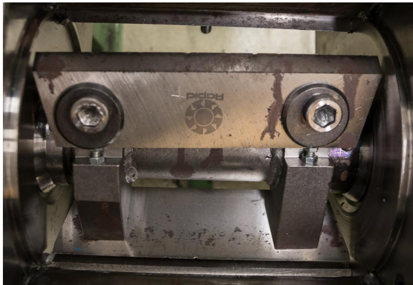
Obr. 31. Pracovní prostor nožového mlýnu
