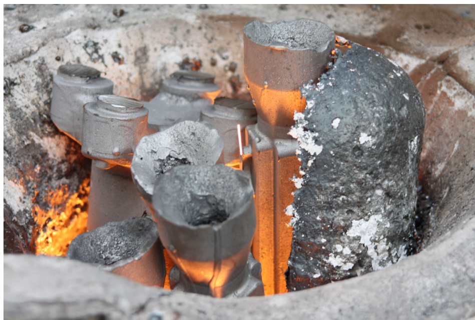
Obr. 20. Tavení materiálu v indukční peci [18]
