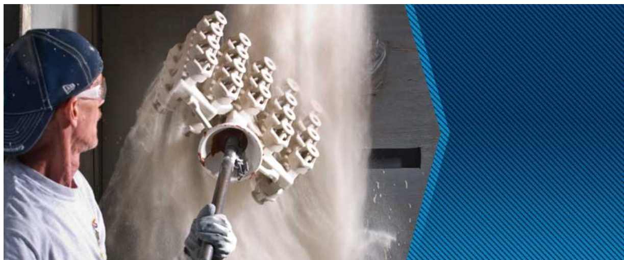
Obr. 14. Obalování stromečku (posyp žárovzdorným materiálem) [20]
