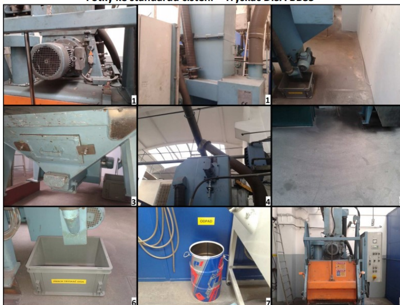
Obr. 59. Standard čištění stroje na pracovišti tryskání
