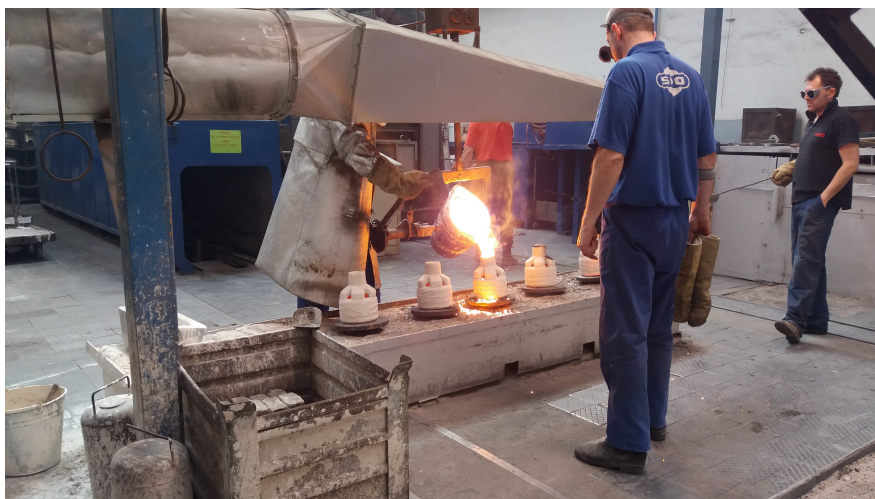
Obr. 44. Odlévání odlitků v SPO Zlín
