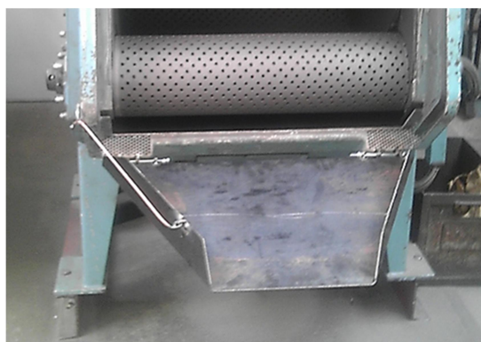
Obr. 64. Instalace skluzavky na tryskač
