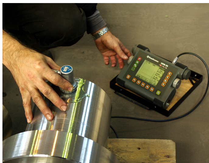
Obr. 35. Zkouška ultrazvuku materiálu [25]
