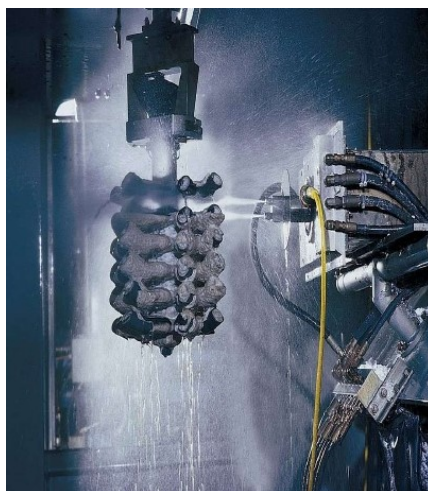
Obr. 27. Vysokotlaké čištění odlitků
