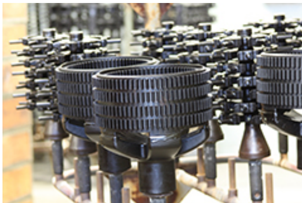
Obr. 41. Sestavené modely na vtokovou soustavu
