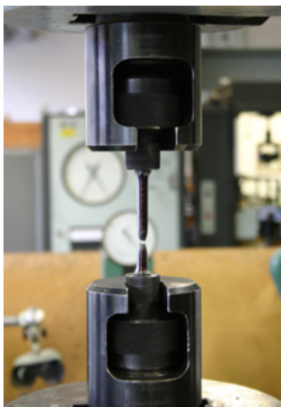
Obr. 33. Tahová zkouška materiálu [25]
