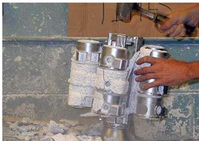
Obr. 26. Ruční oklepávání skořepiny [37]
