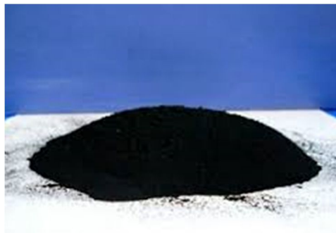
Obr. 3 Základní aktivní plnivo kaučukových směsí-saze
