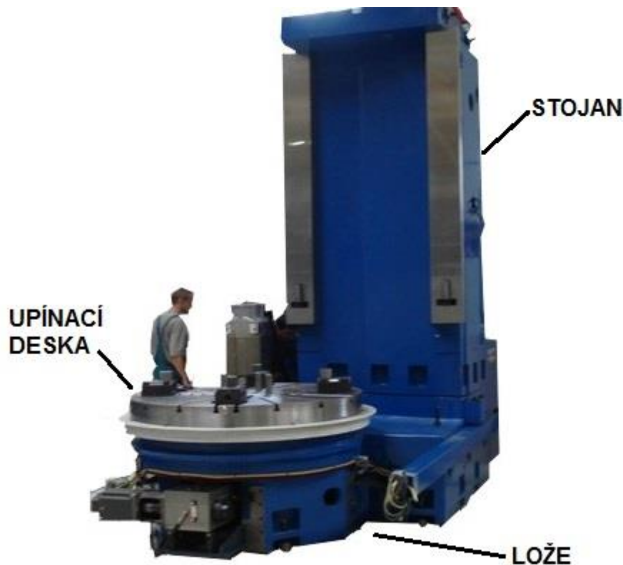
Obrázek 6: Lože, stojan a upínací deska (Interní zdroje)
