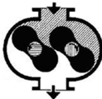
Obr. 19: Uzavřený vzduch mezi stěnou a rotorem [3]
