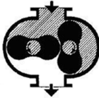
Obr. 20: Vytlačování vzduchu do výstupního otvoru [3]
