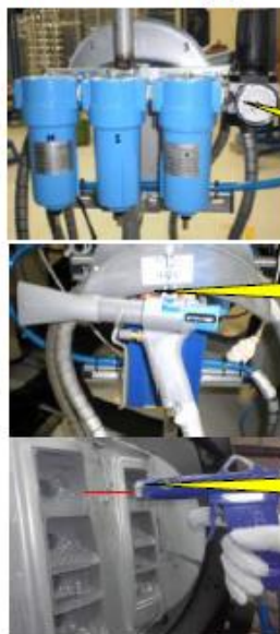
Obr. 58: Tech. postup ofuku ionizačním vzduchem
