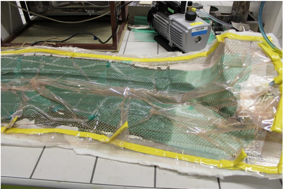
Obr. 33. Průběh vakuové infuze
