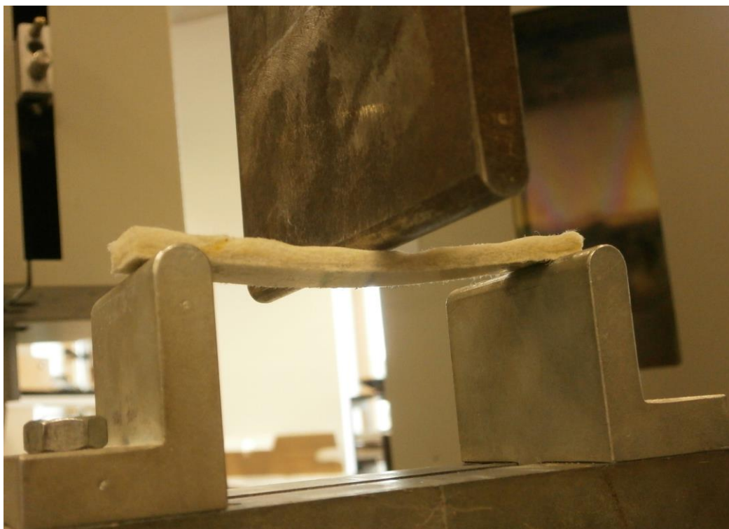
Obr. 35. Zkušební vzorek vyztužený vlákny psí srsti při zkoušce ohybem
