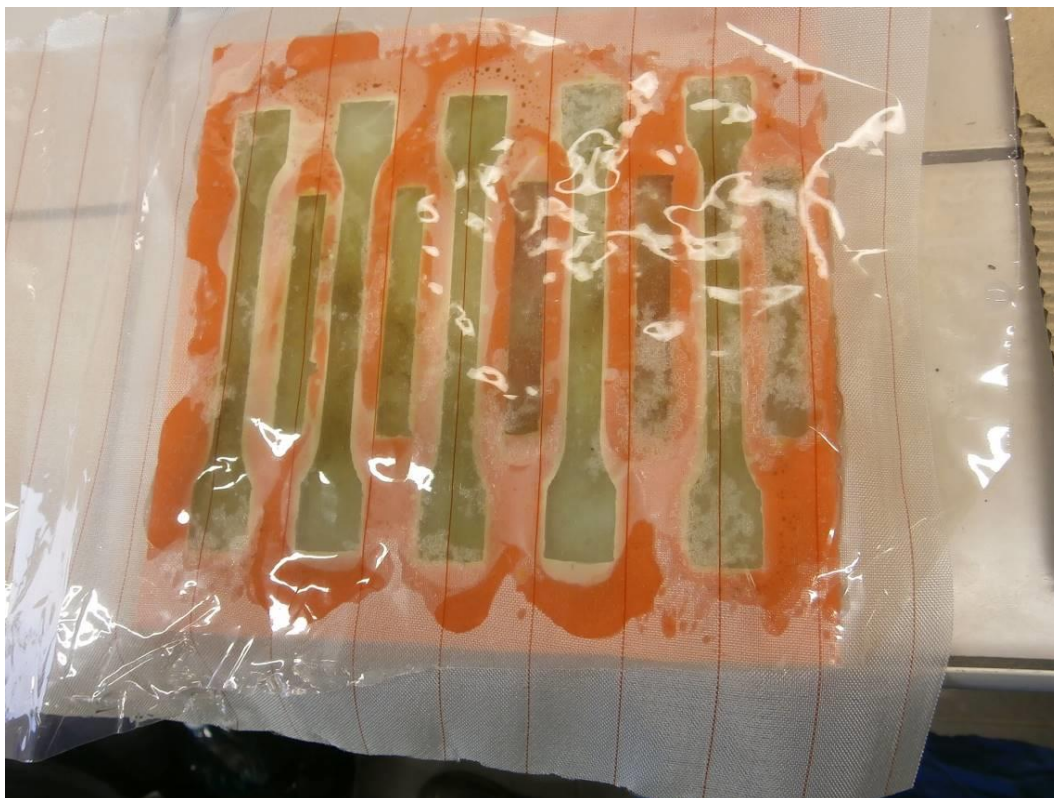
Obr. 18. Zaplněná forma pod fólií
