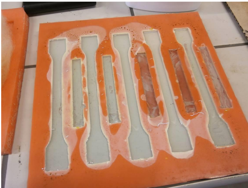
Obr. 16. Silikonová forma s dutinami naplněnými pryskyřicí
