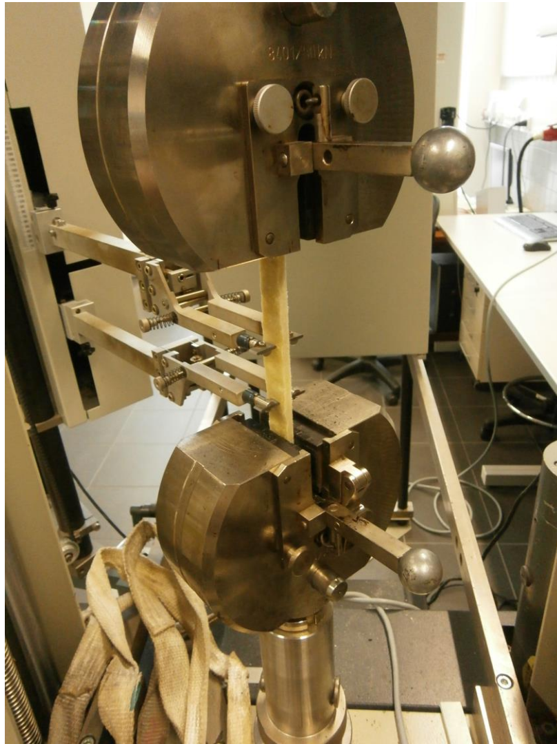
Obr. 37. Zkušební vzorek vyztužený ovčí vlnou při zkoušce tahem
