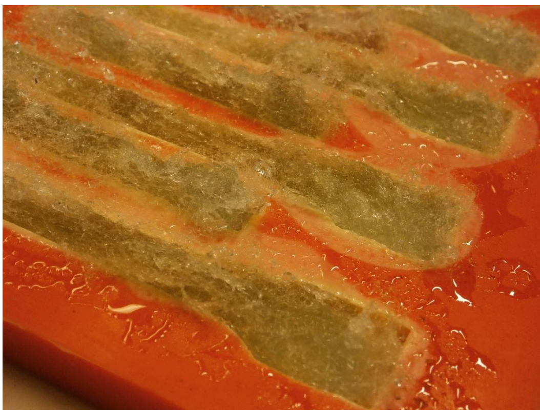
Obr. 17. Detail dutin formy s pryskyřicí a výztuží z ovčí vlny
