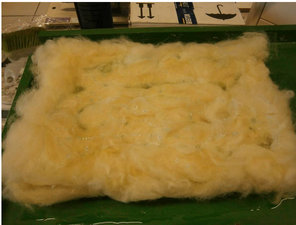
Obr. 22. Prosycená ovčí vlna při výrobě kompozitní desky
