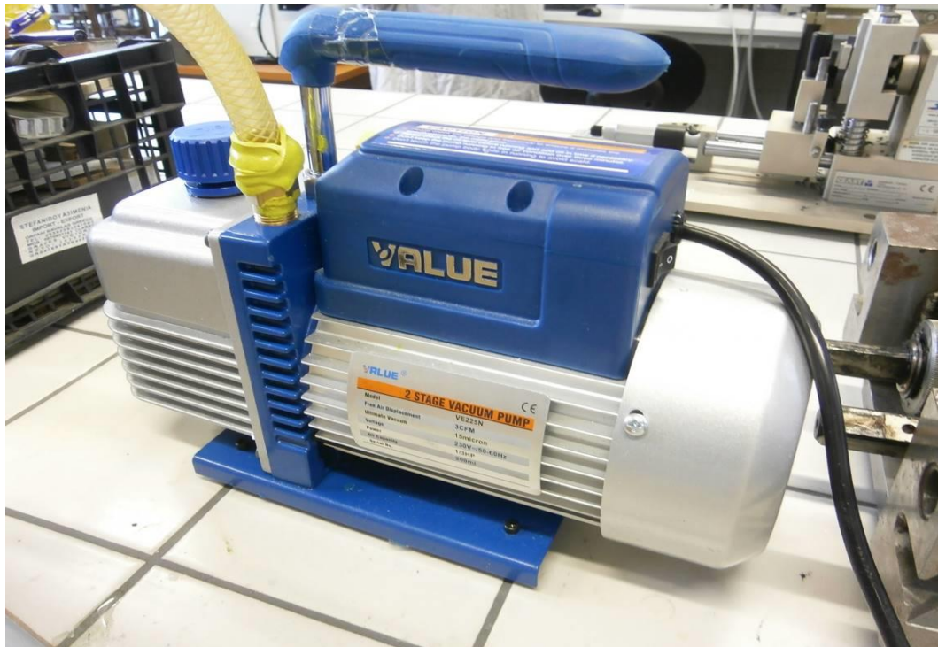
Obr. 20. Dvoustupňová vývěva pro odsátí vzduchu
