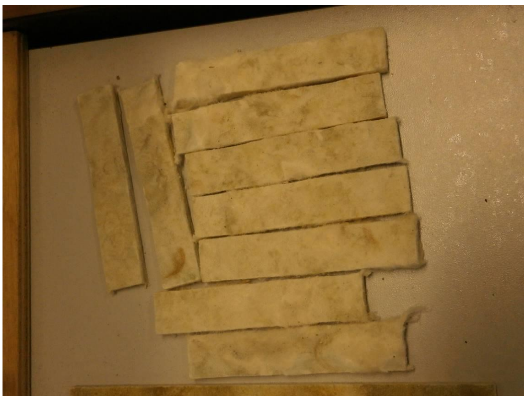
Obr. 33. Porovnávací deska rozřezaná na vzorky
