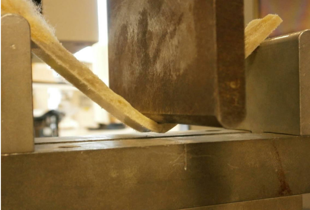
Obr. 36. Zkušební vzorek vyztužený ovčí vlnou při zkoušce ohybem
