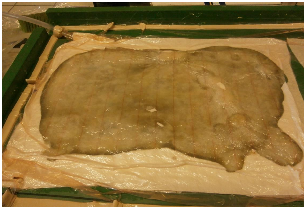
Obr. 23. Prosycená ovčí vlna pod vakuovací folií po odsátí vzduchu
