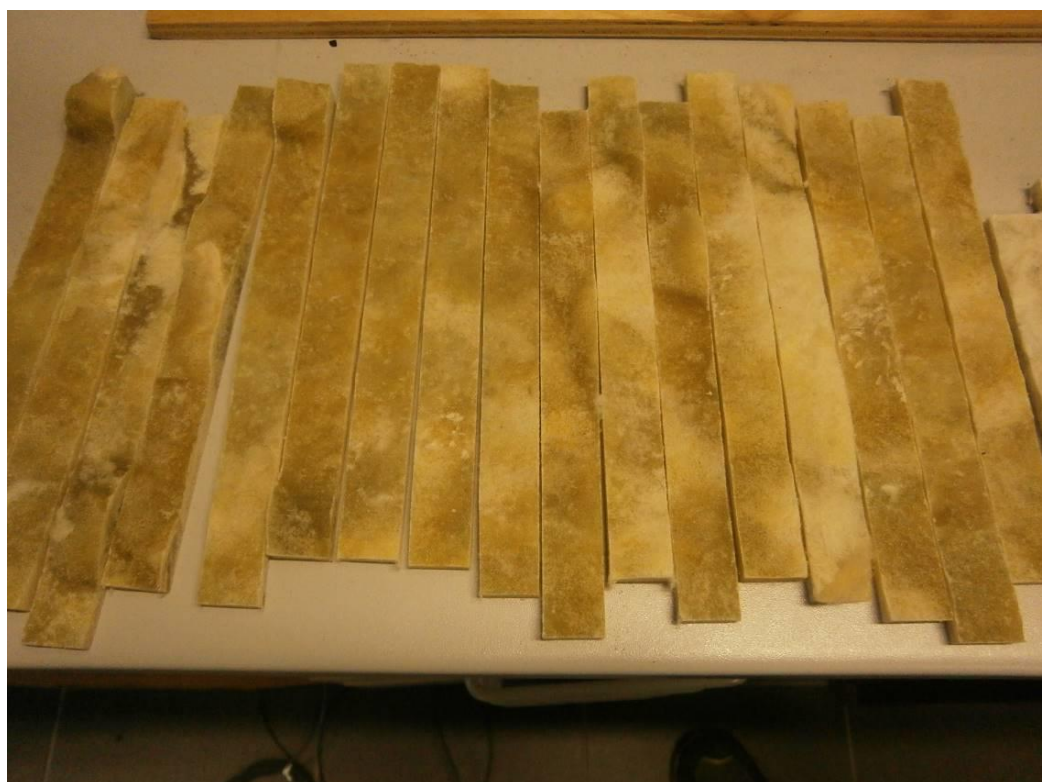
Obr. 26. Rozřezaná deska na vzorky
