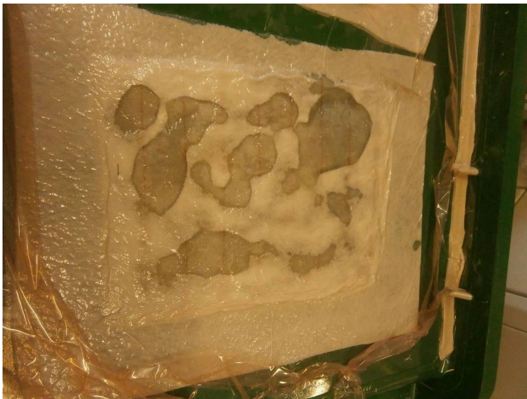
Obr. 30. Prosycená vlákna psí srsti po odsátí vzduchu
