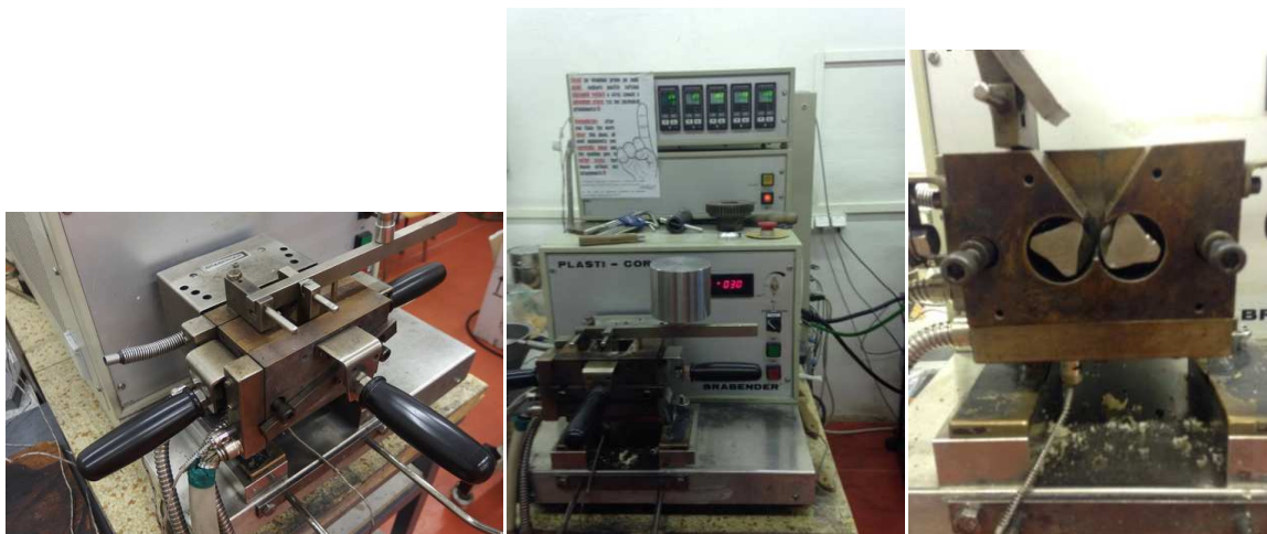
Obr. 19 Hnětič a detail komůrky.
