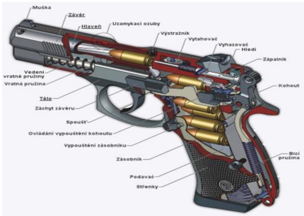
Obr. 43 Popis hlavních částí a ovládacích prvků pistole [51]
