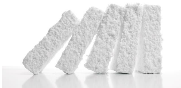
Obr. 10: Bloky bělené sulfátové buničiny [33].
