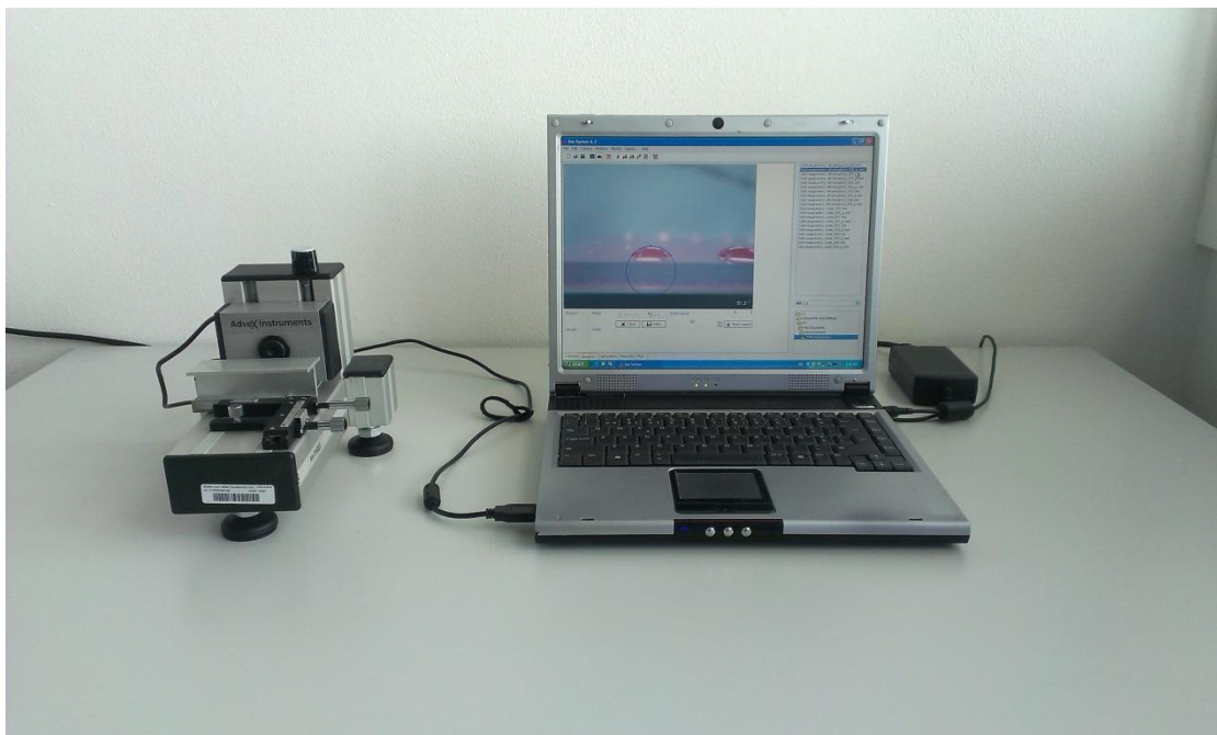
Obr. 13.: Měřicí zařízení „SEE System“ pro měření kontaktních úhlů a vyhodnocování povrchové energie.
