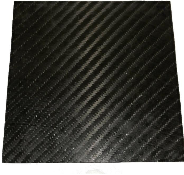
Obr. 60 ukázka vzorku pro zkoušku ČSN EN ISO 15 310
