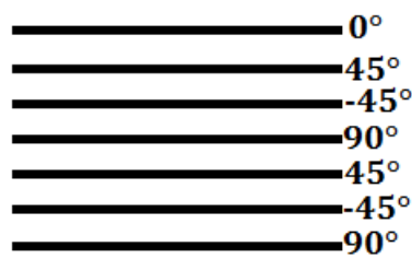
Obr. 46 Skladba výztuže vzorku A
