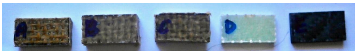
Obr. 57 ukázka vzorků pro zkoušku ČSN EN ISO 14 130
