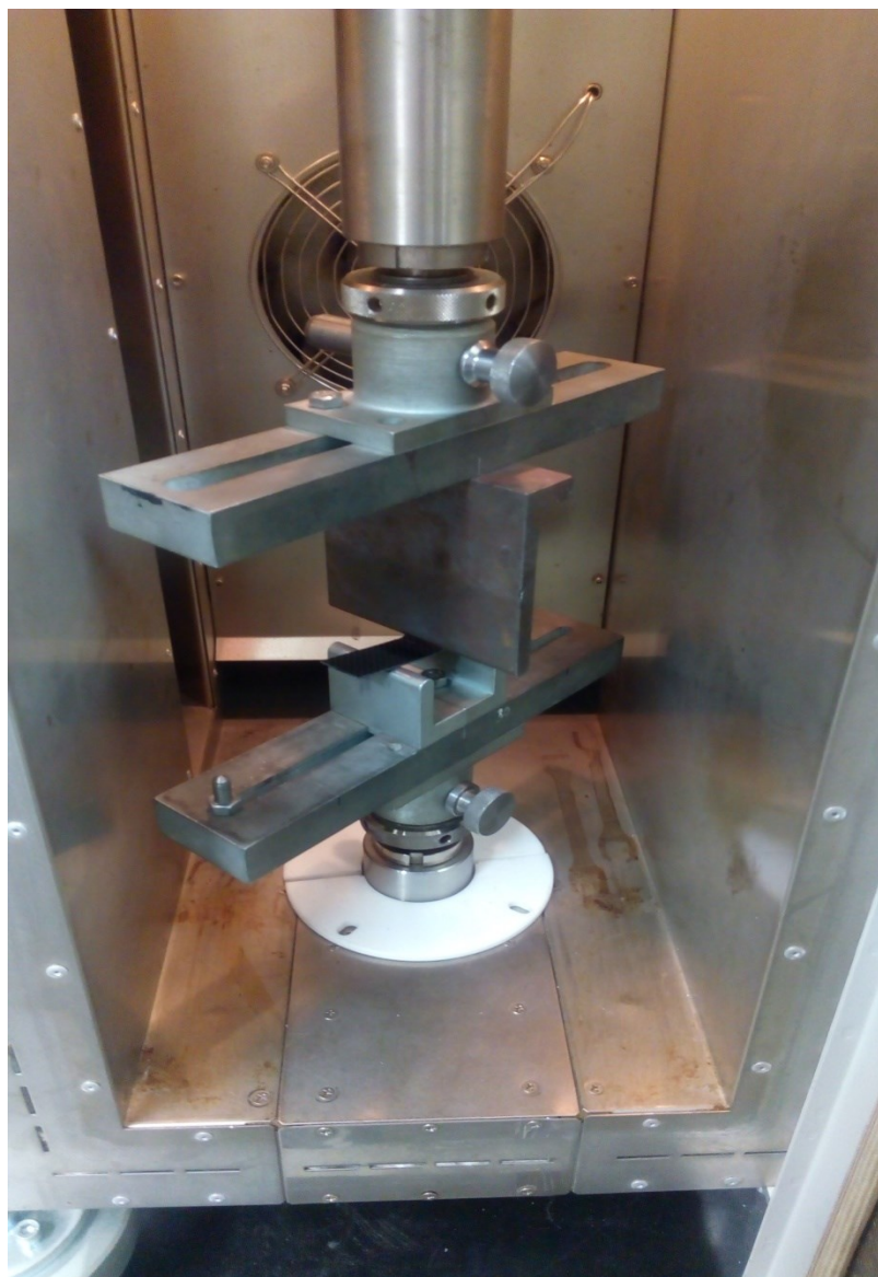
Obr. 28 – Příklad testování třibodovým ohybem v teplotní komoře
