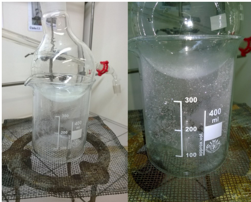
Obr. 20. Sublimace kyseliny benzoové: a) zahřívání baňky s kulatým dnem umístěné na kádince, b) usazování krystalků kyseliny benzoové na dně baňky
