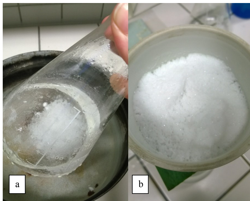
Obr. 18. Příprava kyseliny acetylsalicylové: a) vylučování kyseliny acetylsalicylové, b) vyloučené krystaly odsáté na Buchnerově nálevce
