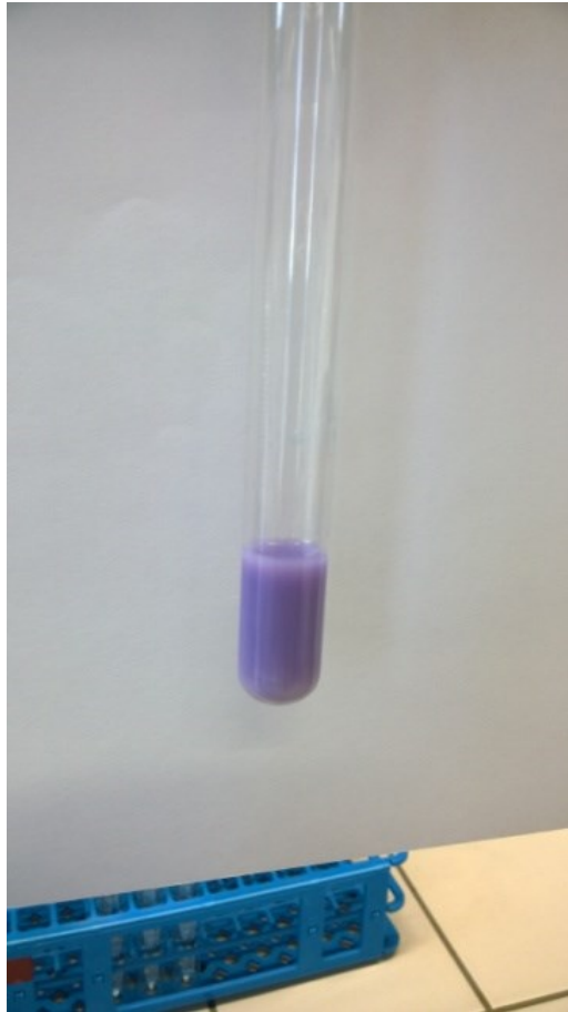
Obr. 16. Biuretová reakce: změna zbarvení mléka z bílé na modrofialovou
