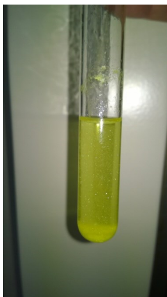
Obr. 26. Jodoformová reakce: zkumavka po odbarvení roztoku a žlutými šupinkami jodoformu
