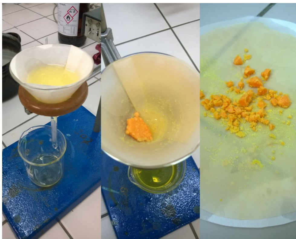
Obr. 30. Nitrace naftalenu: filtrace sraženiny
