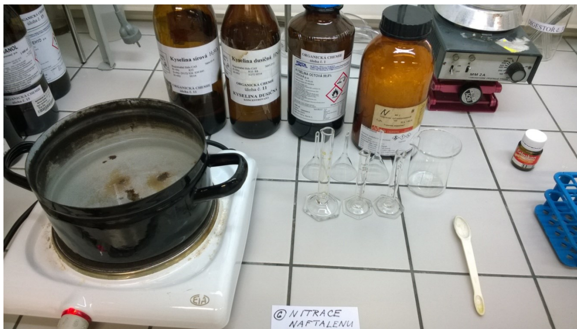
Obr. 29. Nitrace naftalenu: pomůcky a chemikálie potřebné k experimentu
