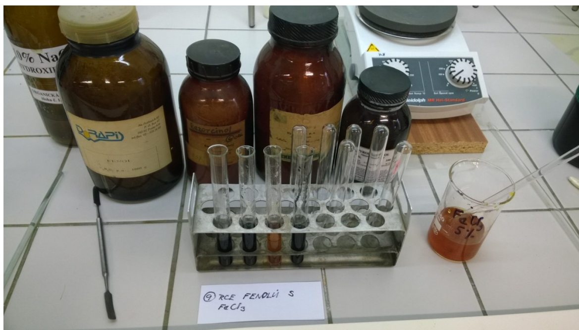
Obr. 27. Reakce fenolů s chloridem železitým: zkumavka s fenolem (fialová), resorcinolem (modrá), hydrochinonem (žlutá) a pyrokatecholem (zelená) po přidání chloridu železitého
