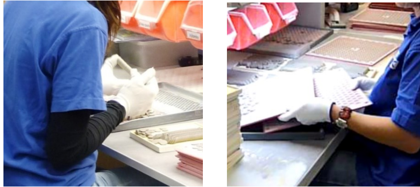
Obr. 14. Očištění pláště od zirkonu a natřepání do lísky (vlastní zpracování)
