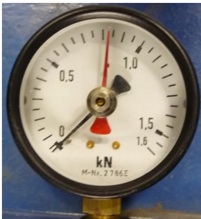
Obr. 21. Měření tlačné a tažné síly vozíku (vlastní zpracování)
