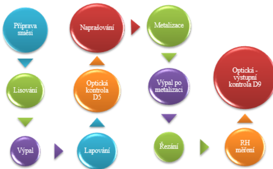
Obr. 7. Postup výroby pozistorů (vlastní zpracování)
