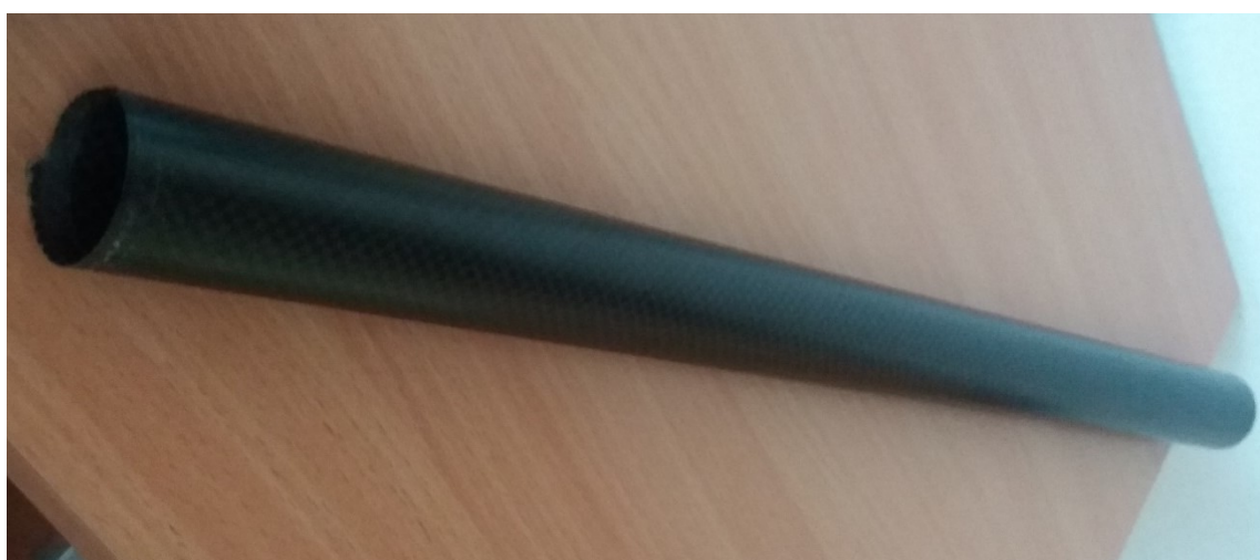
Obrázek 40 Vzorek po vytažení z formy neopracovaný
