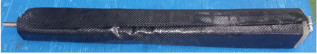
Obrázek 53 Založený prepreg a připraven na vložení do formy
