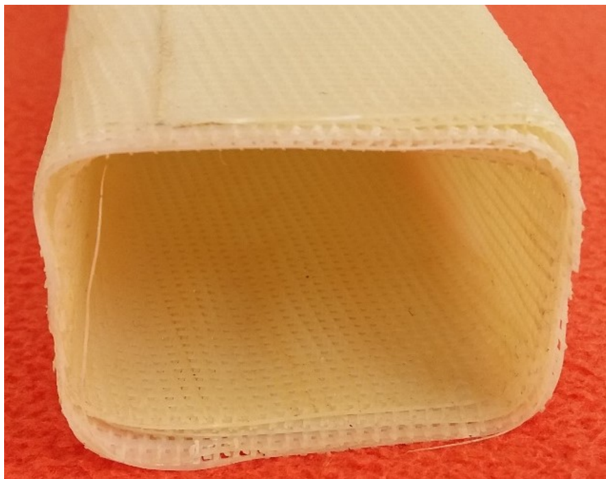
Obrázek 59 Delaminace v rozích vzorku
