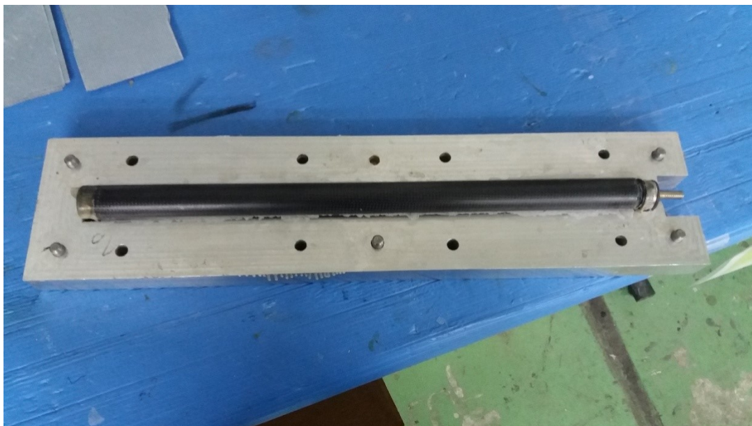
Obrázek 48 Vzorek po odformování
