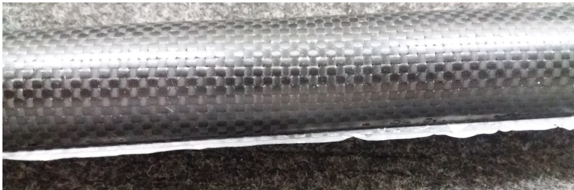
Obrázek 57 Prepreg v dělicí rovině
