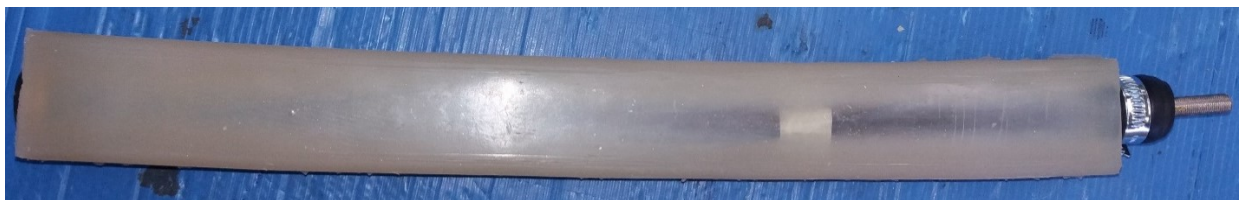
Obrázek 52 Připravená membrána s mezikusem na zakládání prepregu
