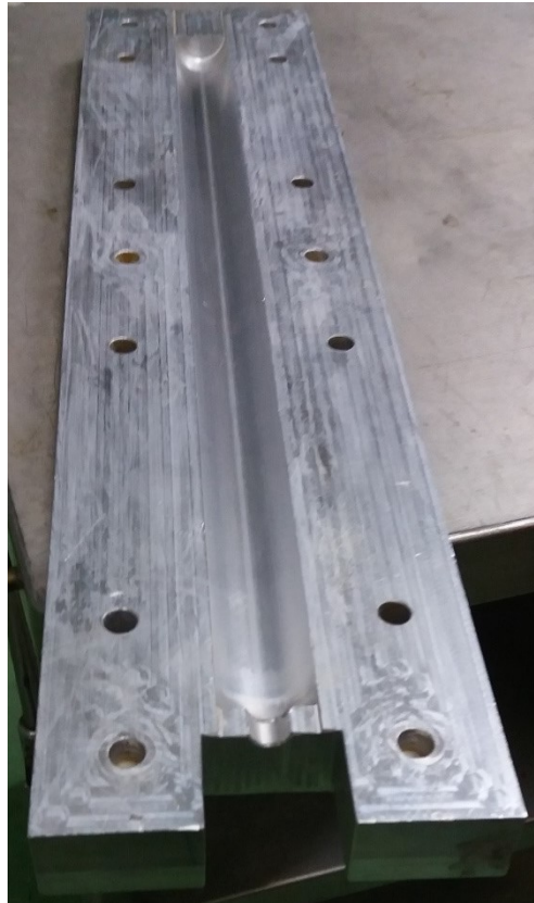
Obrázek 44 Očištěná a naseparovaná forma
