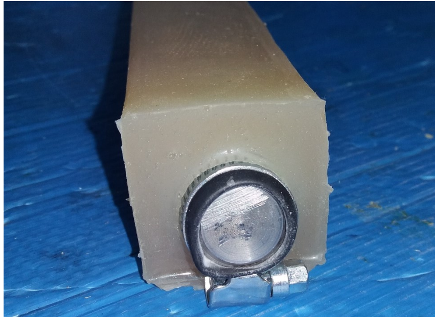
Obrázek 50 Záslepka membrány se silikonovým mezikusem
