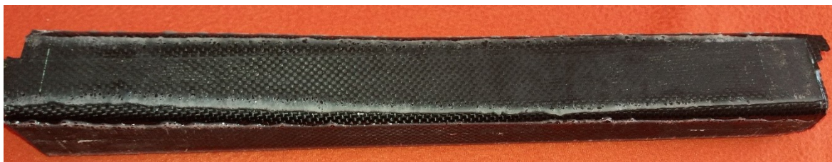
Obrázek 58 Vady při nízkém tlaku v membráně
