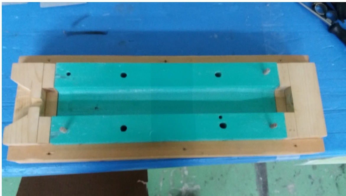
Obrázek 37 Dutina formy čtvercového profilu
