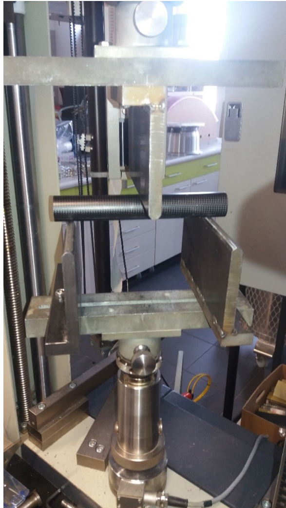
Obrázek 62 Zkouška ohybem kruhového profilu
