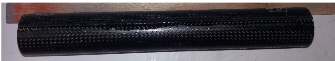
Obrázek 67 Vada vzorku č. 4 špatné prosycení vzorku pryskyřicí
