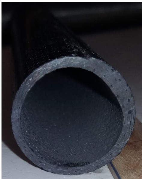
Obrázek 66 Vada vzorku č. 4 pórovitost
