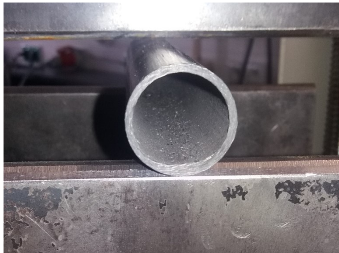
Obrázek 63 Uložení zkušebního tělesa
