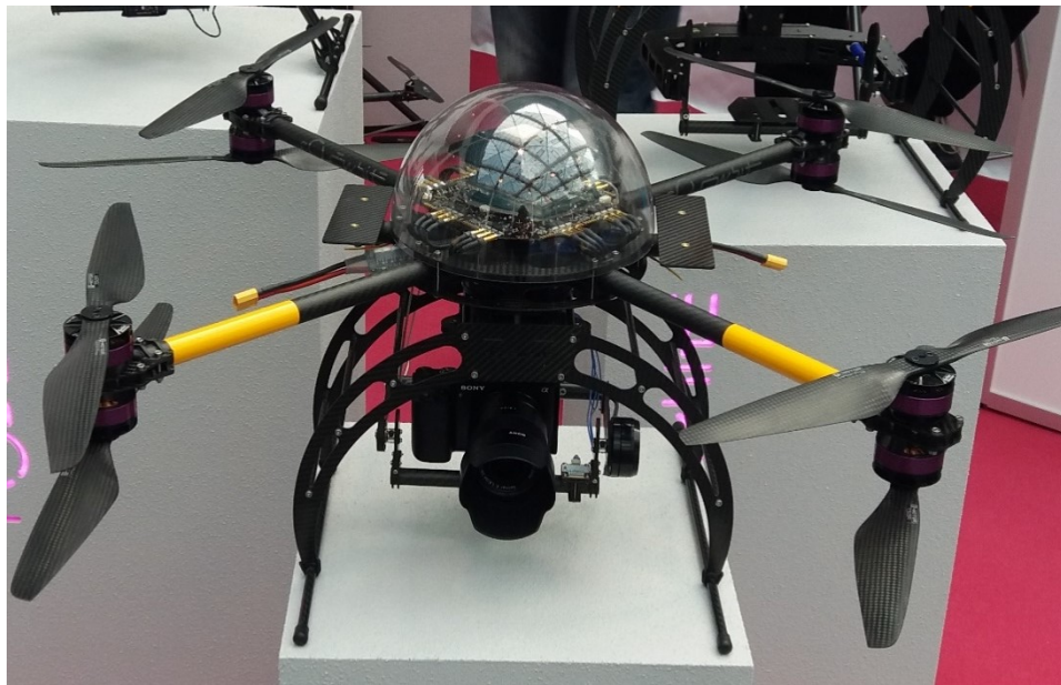
Obrázek 29 Použití pultruzních profilů v letectví
