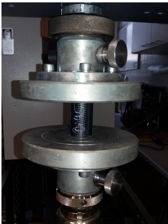
Obrázek 69 Zkouška na tlak po výměně čelistí
