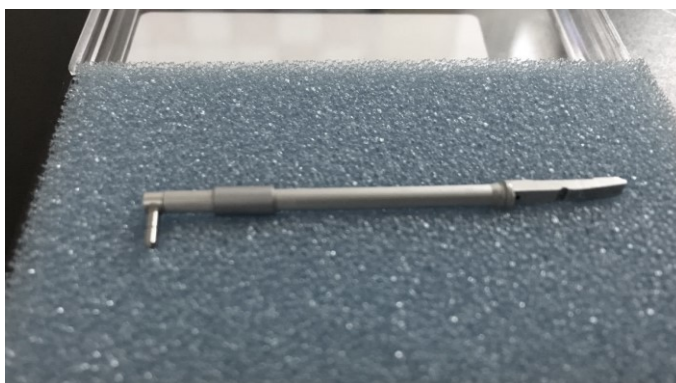
Obr. 41. Použitý dotyk 12AAB403- Mitutoyo SJ-400 5μm
