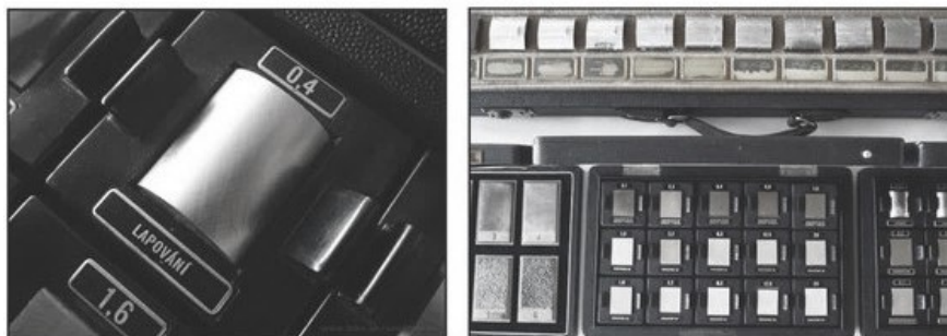
Obr. 35. Jednotlivé vzorky drsnosti povrchu a vzorkovnice
