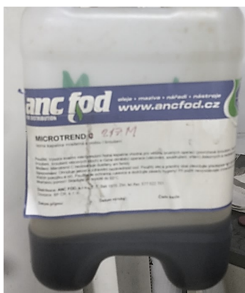
Obr. 48. Použitá chladiaca kvapalina Microtrend 217M
