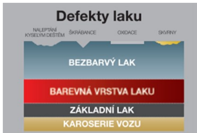
Obr. 14. Ukázka defektu laků [23]
