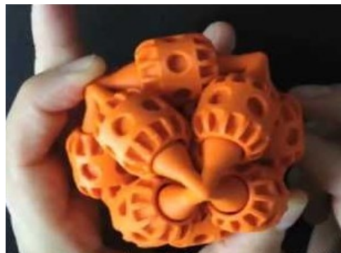
Obr. 10 Nerozebíratelné pohyblivé spojení [22]
