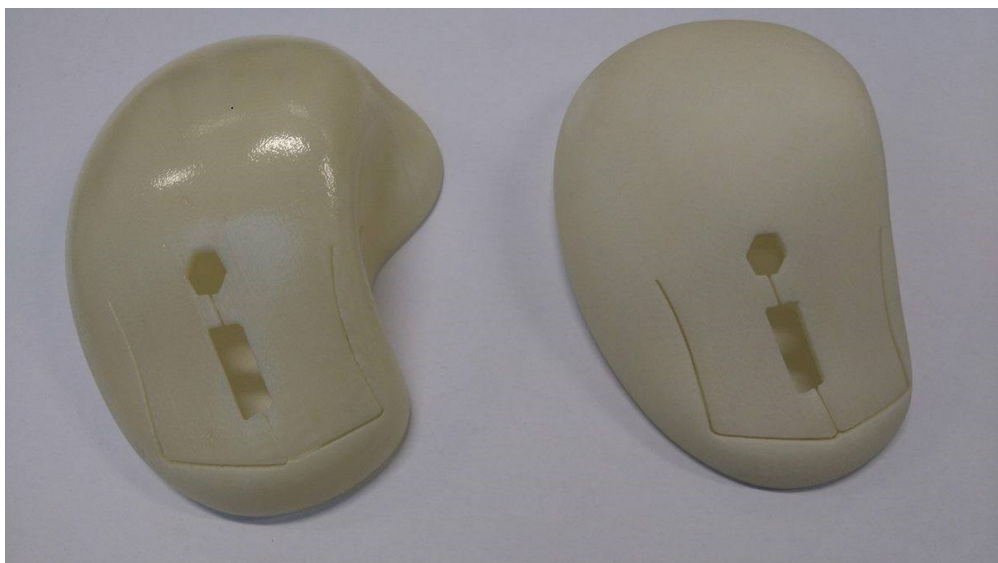
Obr. 53 Rozdíl mezi naleptaným (vlevo) a nenaleptaným (vpravo) povrchem
