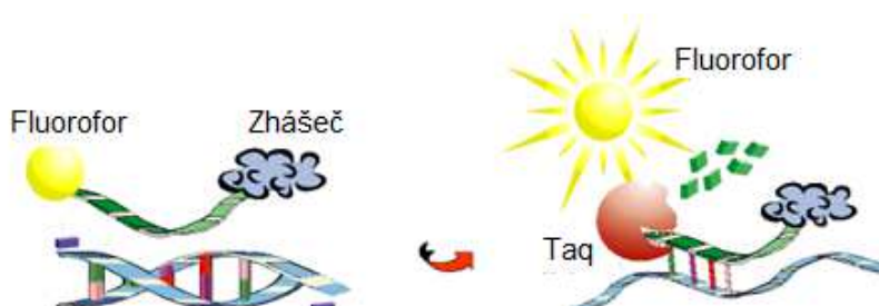
Obrázek 10: Schéma principu fungování sondy TaqMan. [30]
