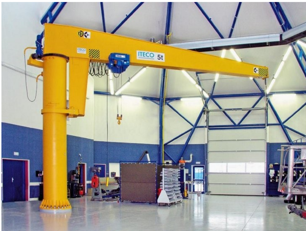
Obr. 26. Otočný jeřáb společnosti Iteco s nosností 5 t a vyložení 9 m. Podobný jeřáb společnost plánuje pořídit. [19]
